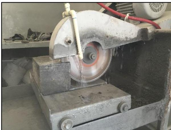
Figura 30. Cortadora con disco de diamante.
