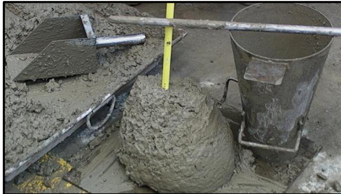
Figura 26. Medición del revenimiento de concreto.
