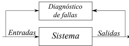
Figura 2.1: Sistema de diagnóstico de fallas
