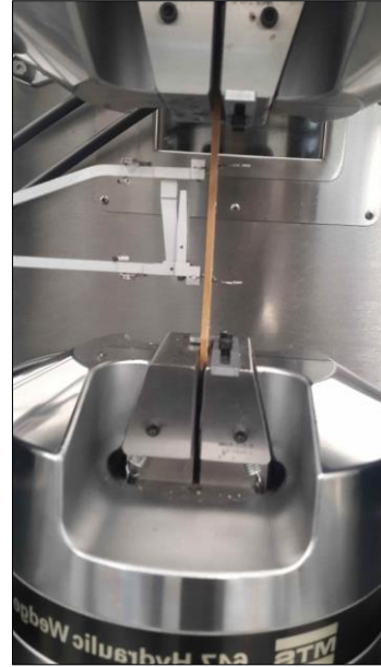
b) extensómetros utilizados en las pruebas
