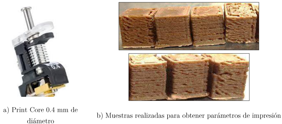
Figura 3.2. Print core y muestra realizadas que permitieron elegir parámetros de manufacturación
