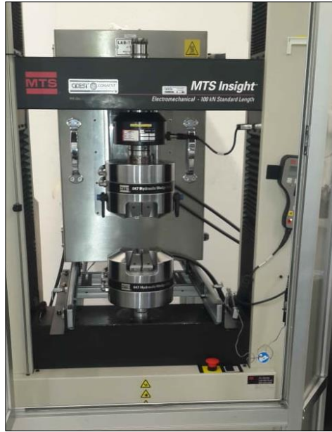
a) Máquina de ensayos mecánicos
