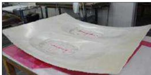
c) Panel lateral interno de aeronave Boeing hecho con MC reforzados con fibras vegetales.
