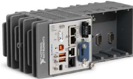
Figura 4.16: Sistema de control embebido cRIO 9030
