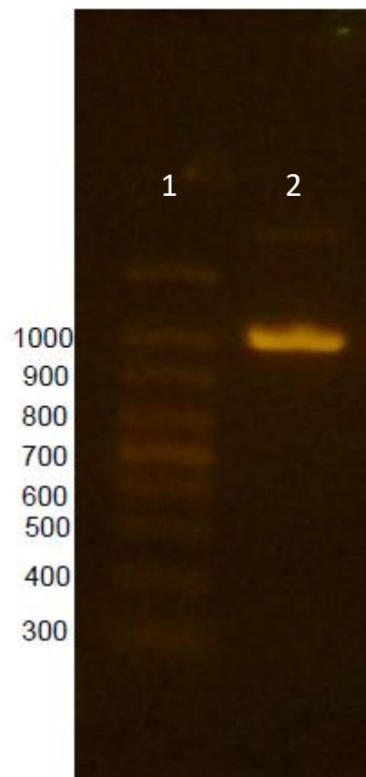
Figura 9. Electroforesis del fragmento amplificado después de la purificación. (1) Marcador de peso molecular, (2) Muestra.
