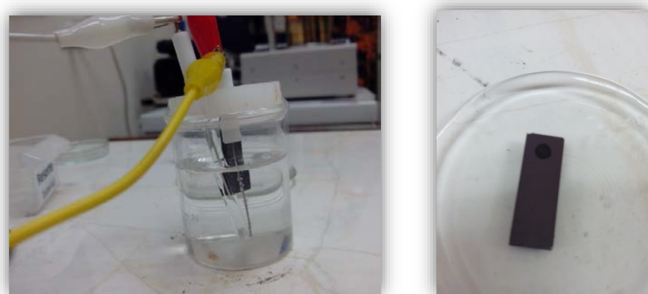
Figura 9. Celda de tres electrodos y carbón vítreo con el \text{FeS}_2 .
