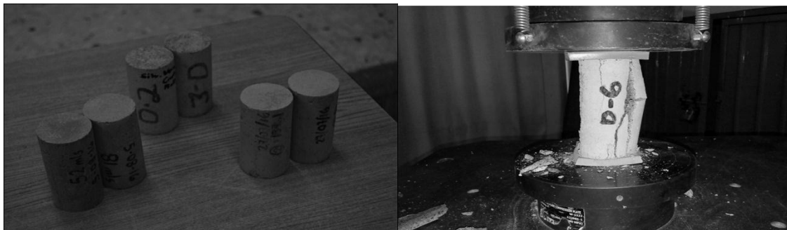
Figura 5. 5: Especímenes de la Segunda Serie Experimental, sometidos a compresión.
