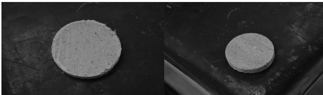
Figura 5. 6: Discos circulares obtenidos de las Muestras D-09 y D-10 para la prueba de SEM
