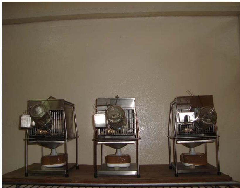
Figura 12. Cajas metabólicas para recolección de orina de 24 hrs.
