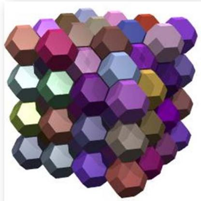
Figura 1.3.- Estructura Weaire-Phelan formada por tetracaidecaedros [12].
