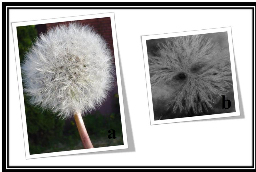
Figura 1.1. a) Semillas de diente de león, b) esferulita de poli-cis-1,4-isopreno cristalizado durante 2 Hrs. a  $-26\text{ }^{\circ}\text{C}$ , observada mediante microscopía electrónica de transmisión TEM (25,000X).
