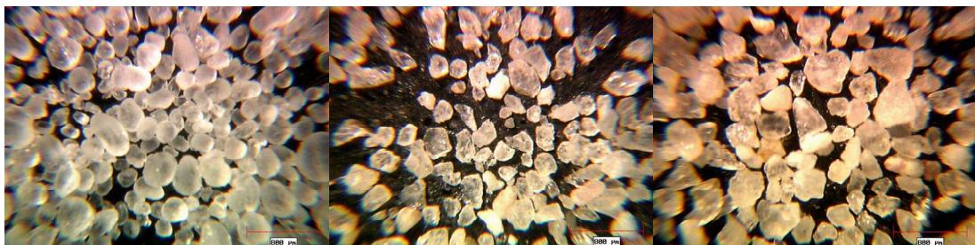
Figura 2.3. Morfología de grano redondo, sub-angular y angular de la arena sílica.
