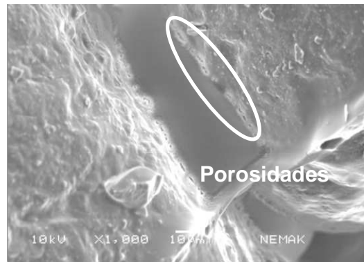
Figura 4.39. Micrografía por SEM. Puentes entre los granos de arena y el silicato por el proceso de caja fría.
