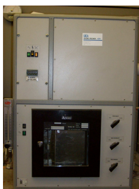
Figura 3.17. Equipo DISA George Fisher para la medición de la evolución de gases.
