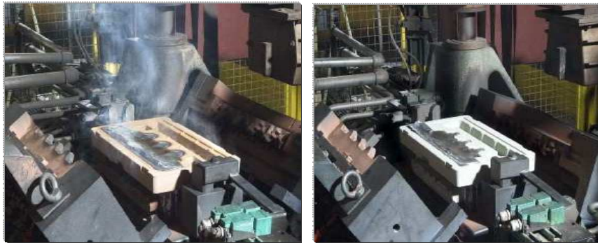
Figura 2.7. Producción de piezas de aluminio y formación de emisiones usando corazones orgánicos (izquierda) y corazones inorgánicos (derecha).
