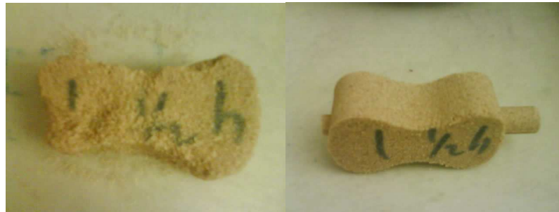
Figura 4.22. Aspecto de una probeta arenosa y lisa.
