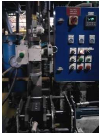
Figura 3.10. Sopladora Redford de caja caliente para elaboración de probetas.
