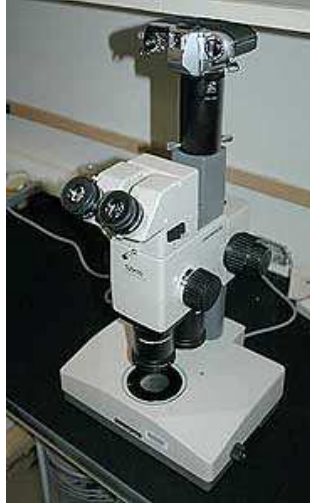
Figura 3.3. Estereoscopio Olympus SZH10.
