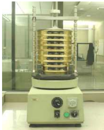
Figura 3.2. Agitador de mallas Simpson utilizado para realizar el análisis granulométrico.
