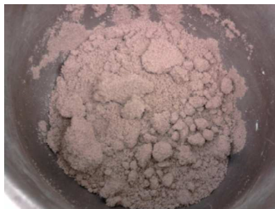
Figura 4.25. Aspecto de la arena mas silicato al momento en que se ha secado.
