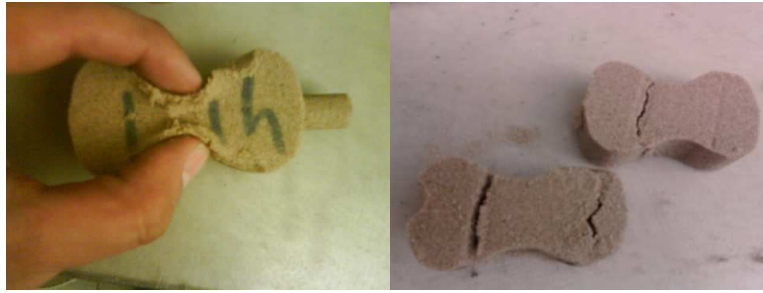
Figura 4.30. Probetas después haber estado a altas condiciones de humedad.
