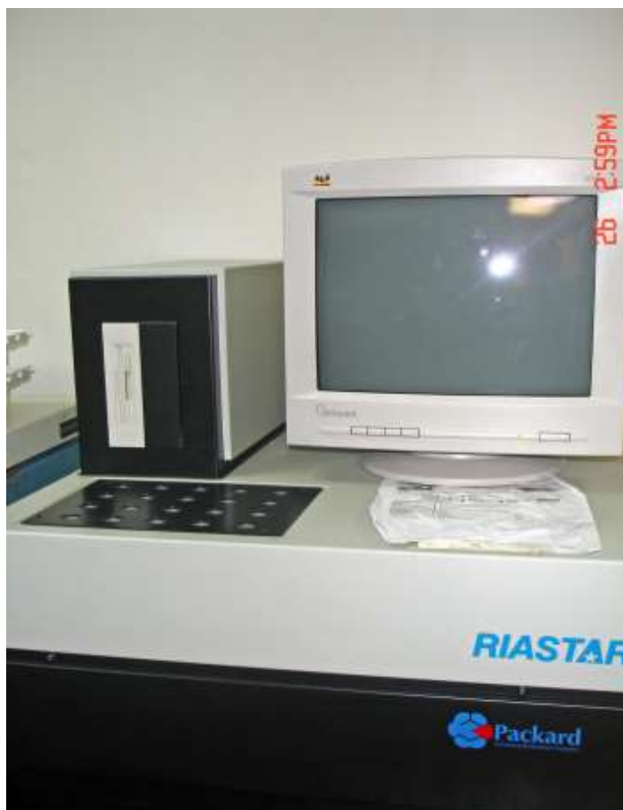
Figura 10. Contador Gama con capacidad de reducción de datos empleado para los cálculos de la Leptina humana.
