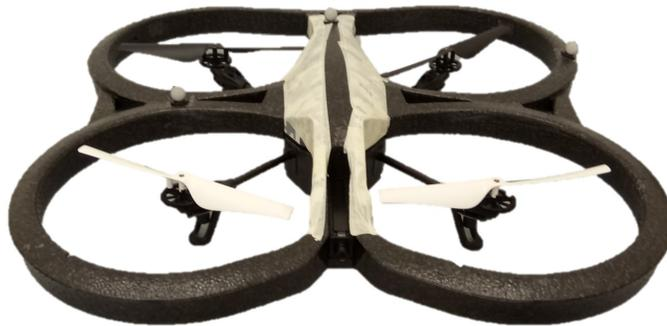
Figura 5.1: Esferas reflejantes ancladas en el Cuadrirrotor Parrot<sup>®</sup> AR.Drone 2.0.
