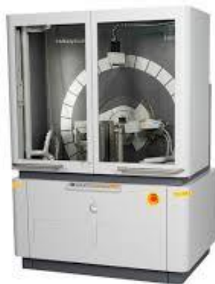
Figura 19: Difractómetro de Rayos X marca PANalytical-Empyrean.
