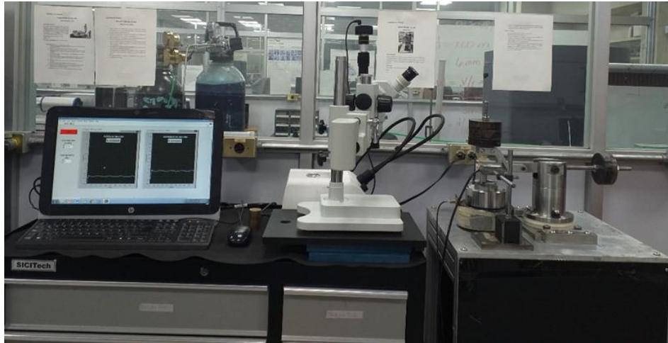
Figura 23: Máquina de ensayos tribológicos Ball on Disc STT.
