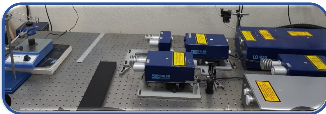
Figura 12: Láser Nd: YAG empleado para la obtención de las nanopartículas de \text{TiO}_2 negro.
