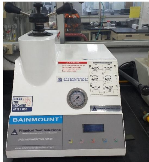
Figura 16: Prensa de montaje de muestras empleadas en el proceso de prensado en caliente.
