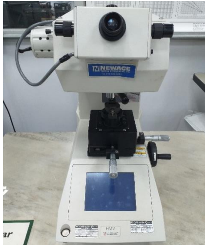
Figura 21: Microdurómetro digital HMV-2 Shimadzu
