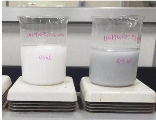
Figura 15: Mezcla del polvo de UHMWPE con las nanopartículas de \text{TiO}_2 blanco y \text{TiO}_2 negro.
