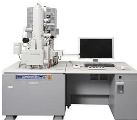
Figura 18: Microscopio electrónico de barrido (MEB) de emisión de campo Hitachi SU8020.
