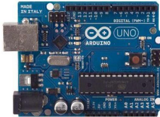
**Figura 10** Hardware: placa de circuito impreso Arduino
