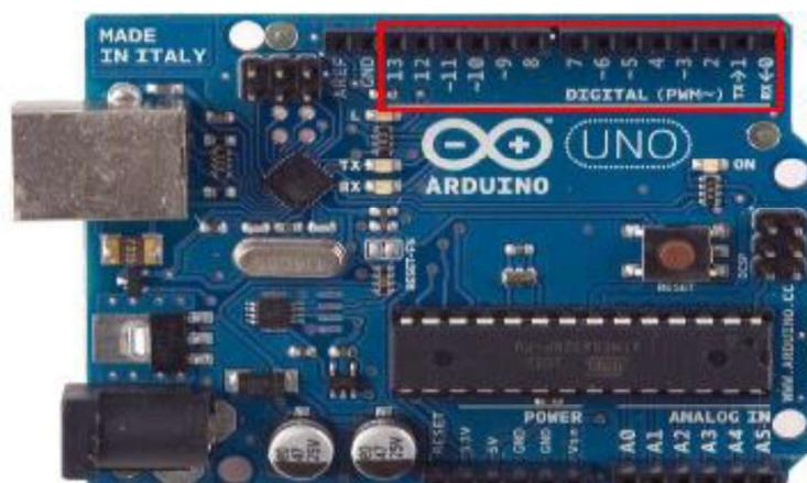
**Figura 12.** Pines digitales de entrada y salida
