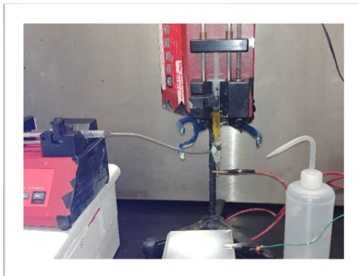
Figura 12.- Equipo utilizado para electrohilado coaxial
