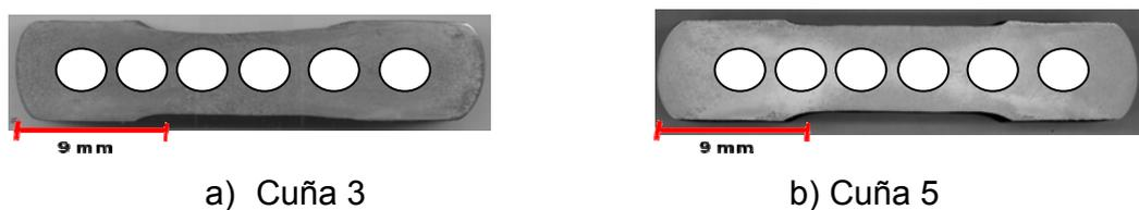
**Figura 4.10** Las muestras en forma de cilindros ya maquinadas se obtuvieron del centro de las secciones de cada cuña.
