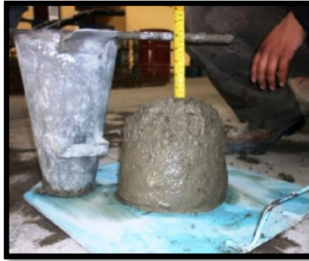
Fig.75 Revenimiento del concreto en estado fresco.
