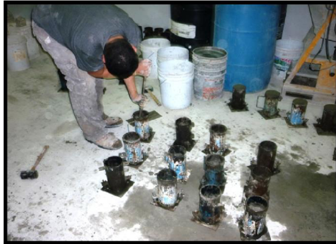
Fig.72 Compactación del concreto durante la fabricación de los cilindros.
