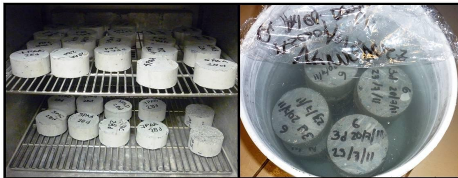
Fig.82 Corte e identificación de las rodajas para su posterior uso.
