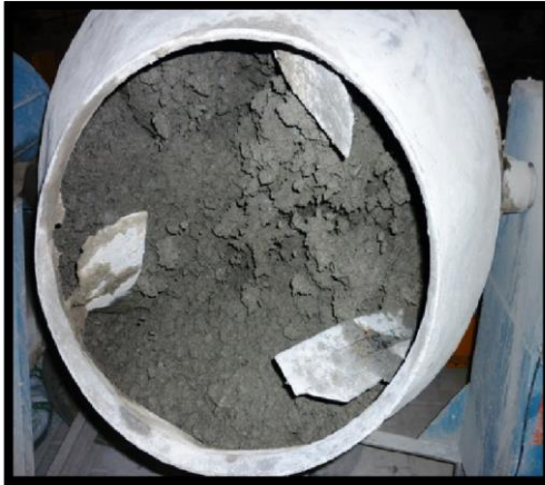
Fig. 70 Mezclado del concreto de referencia donde se observa la cohesividad de la pasta.
