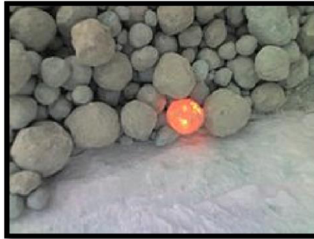
Fig. 2 Clínker recién salido del horno
