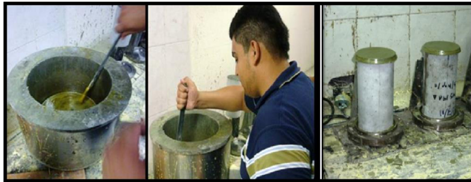
Fig. 77. Preparación del azufre para el cabeceo de los cilindros de concreto.
