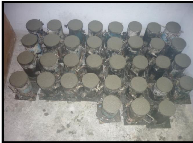
Fig.73 Especímenes cilíndricos después del acabado final.
