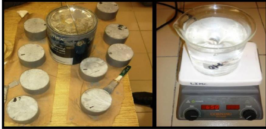
Fig. 85 Preparación de especímenes y solución de \text{Ca}(\text{OH})_2 .
