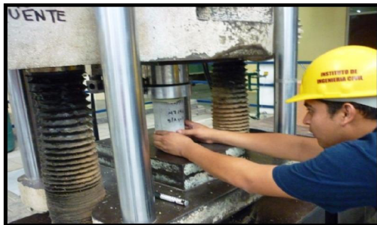
Fig.78. Ensaye mecánico a compresión en maquina universal.
