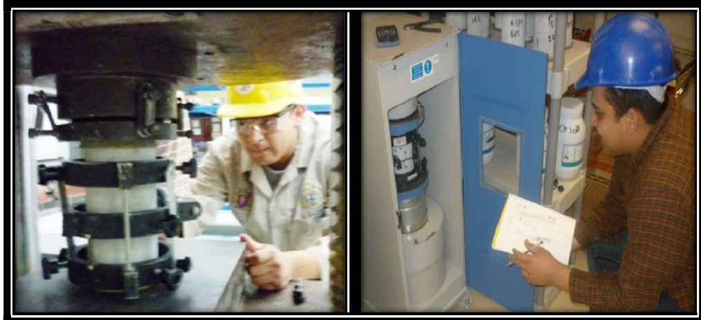
Fig.79 Se toman las lecturas con el medidor mitutoyo en la maquina universal durante el ensaye.
