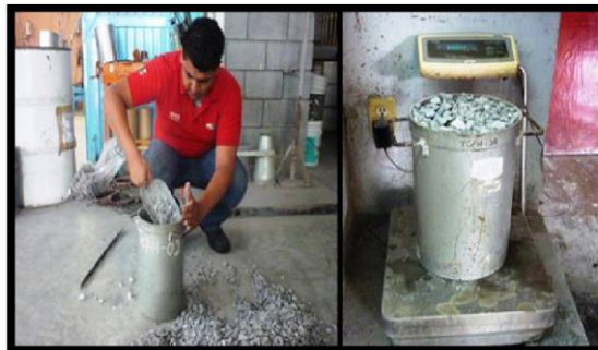
Fig.64 Procedimientos para obtener la humedad de la obra y el peso volumétrico.
