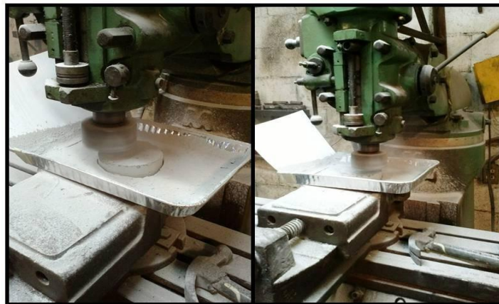
Fig.89 Recolección de los polvos después del maquinado.
