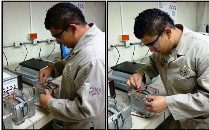
Fig. 83 Preparación de los especímenes para la prueba de permeabilidad rápida a los iones cloruro.
