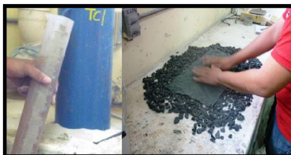
Fig. 65 Determinación de absorción y volumen desplazado de los agregados
