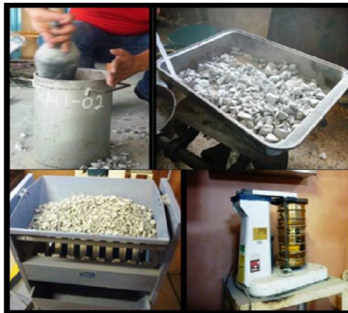
Fig. 63 Separación y tamizado del agregado grueso.
