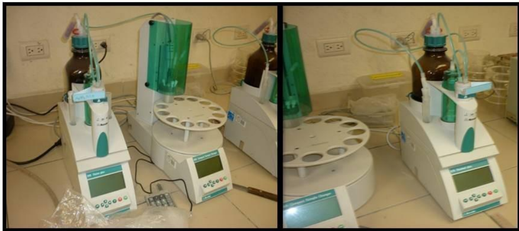
Fig.93 Titulador utilizado para la medición de los porcentajes de cloruros en los concretos a diferentes profundidades.
