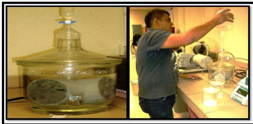
Fig.86 Procedimiento interno para saturación de los especímenes con agua destilada.
