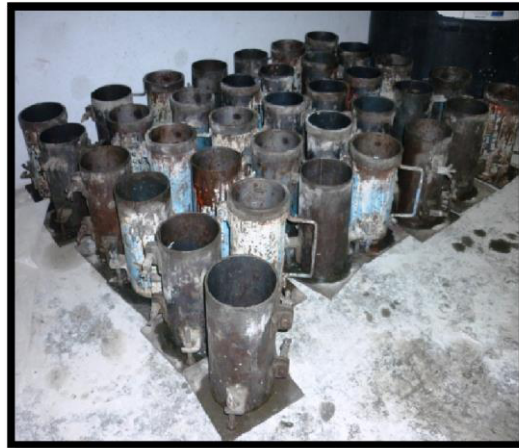
Fig. 68 Moldes metálicos para vaciar el concreto.
