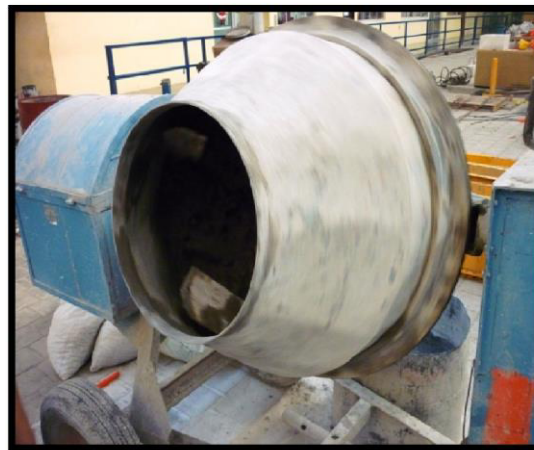
Fig. 69 Máquina revolvedora utilizada para producir el concreto
