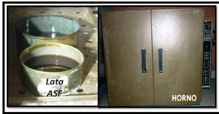
Fig. 66 Procedimientos para obtener los contenidos de sólidos den los aditivos.
