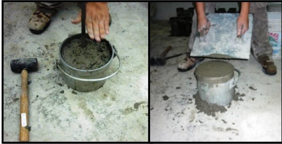
Fig.74 Llenado y enrasado para determinar posteriormente su masa
