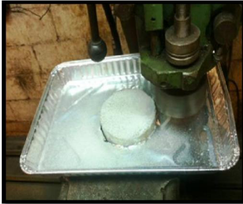
Fig.88 Desbaste de los fragmentos expuestos a los cloruros
