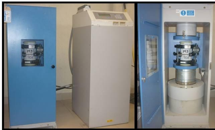
Fig.80 Máquina de ensayos mecánicos a compresión y medidor de la deformación longitudinal del concreto
