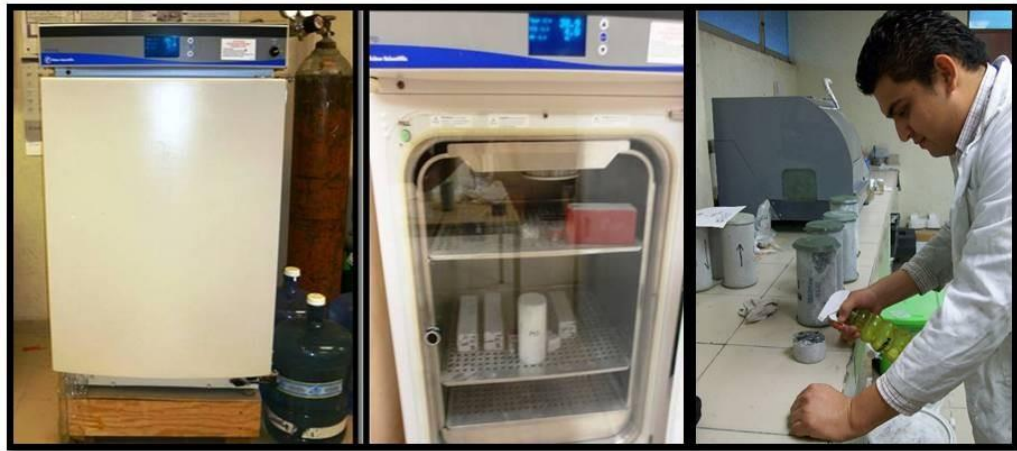
Fig. 61 Cámara de carbonatación acelerada y método de rociado de fenolftaleína para probetas de concreto
