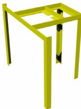
**Figura 5.7** Dibujo de la vista general del soporte superior [8].
