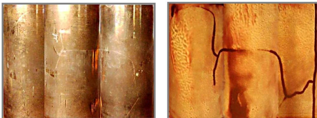
**Figura 6.14** En la imagen izquierda se muestra la superficie extendida de la probeta 2, con un patrón de agrietamiento similar al de la probeta 1. Derecha: misma superficie con líquidos penetrantes y revelador. Nota: Se aplicó un efecto de bordes a la imagen para remarcar el patrón de agrietamiento.
