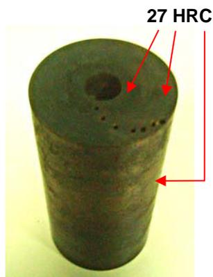
**Figura 6.3** En esta imagen se muestra la probeta de acero D2 después de 500 ciclos térmicos. Se indican las zonas de las lecturas de dureza. Se encontró que la dureza había disminuido de 60 HRC en la condición inicial a un valor final de 27 HRC.
