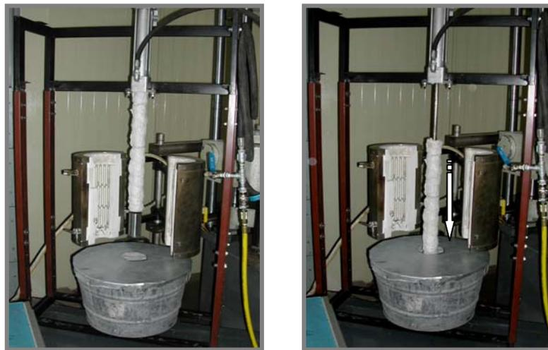
**Figura 5.2** En estas imágenes se muestra el desplazamiento del espécimen de la zona dentro del horno en la etapa de calentamiento hacia la zona del depósito de agua en la etapa de enfriamiento. En la imagen derecha se observa como la extensión, recubierta por un aislante cerámico, queda expuesta dentro del horno durante la etapa de enfriamiento del espécimen. Ambas fotografías fueron tomadas con el horno abierto para fines ilustrativos.
