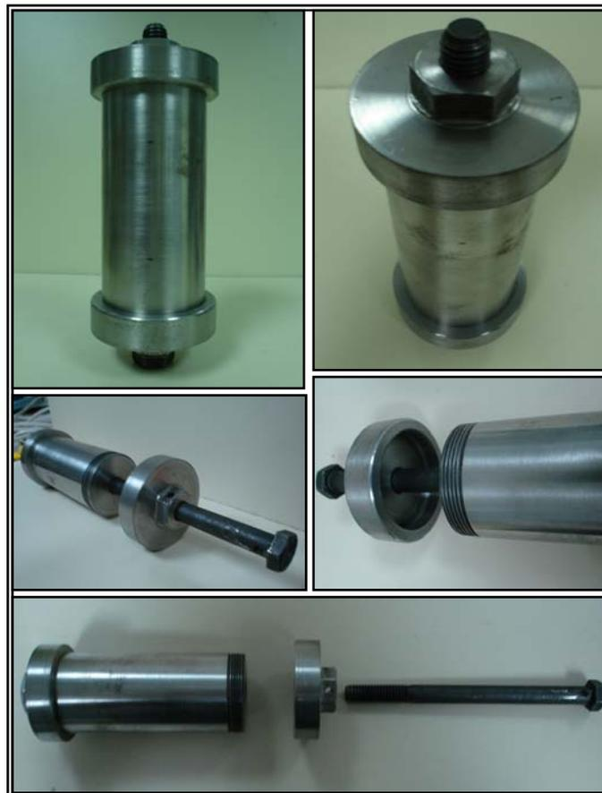
**Figura 5.28** Se muestran una serie de imágenes del subsistema de sujeción ensamblado y sin ensamblar.
