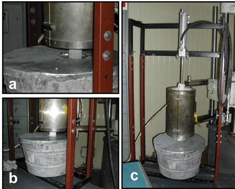
**Figura 5.4** En estas tres imágenes se observa el detalle de la etapa de enfriamiento. (a) Vista entre la parte inferior del horno y la parte superior del depósito de agua, se aprecia como el espécimen sale de la parte interior del horno y se dirige hacia el depósito, (b) el espécimen se encuentra sumergido dentro del depósito de agua, (c) vista general de la etapa de enfriamiento con el actuador neumático activado.
