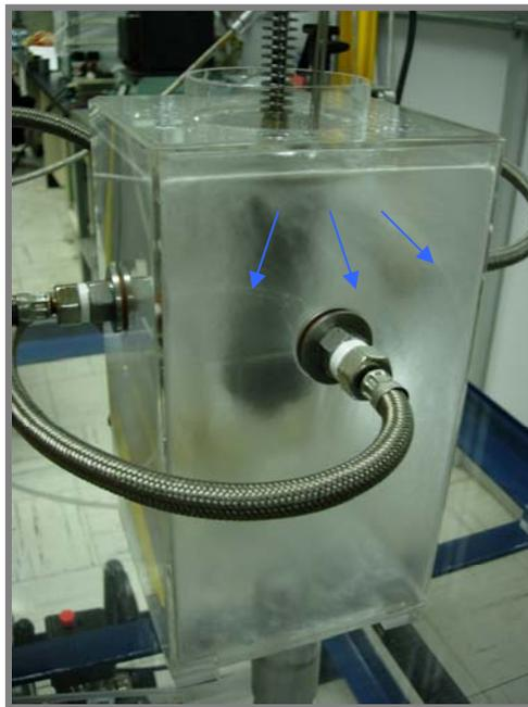
**Figura 6.11** Imagen de la etapa de enfriamiento. Se aprecia la probeta de ensayos envuelta en un baño de agua dentro de la cámara de enfriamiento rediseñada, en la cual no se observaron fugas. Se aprecia como se retorna el agua en la parte superior (flechas) después de chocar con una sección rediseñada de la tapa.
