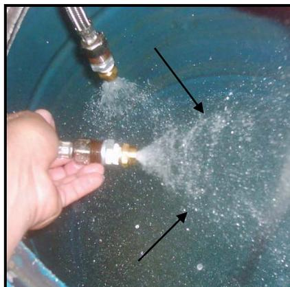
**Figura 5.16** En la imagen es posible identificar el patrón de aspersión de la boquilla tipo “*oval spray*”, durante las pruebas preliminares de análisis y selección del patrón de aspersión de impacto.
