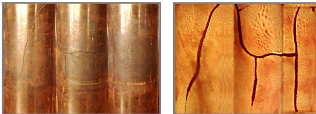
**Figura 6.13** Izquierda: se muestra la superficie extendida de la probeta 1, después de 28 ciclos, donde se aprecia el patrón de agrietamiento a nivel macroscópico típica en la superficie producida por choque térmico. Derecha: misma superficie con líquidos penetrantes y revelador.
