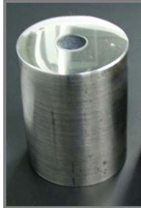
**Figura 5.35** Imagen de una sección de barra de acero D2 con un tratamiento térmico de endurecimiento, y una de sus caras pulidas a acabado espejo.
