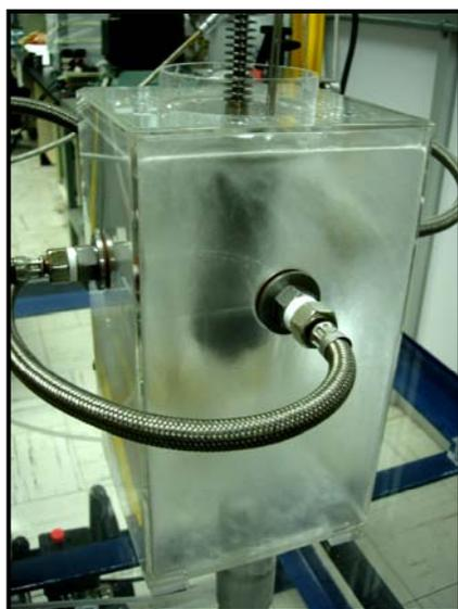
**Figura 5.31** Imagen de la MEFT durante la etapa de enfriamiento. Se aprecia la probeta ubicada dentro de la cámara de enfriamiento.
