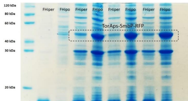
Figura 16. SDS-PAGE 12% de la extracción periplásmica de TorAps-SmbP-RFP. FHiper= fracción hipertónica, FHipo= fracción hipotónica. Como control negativo se utilizó E. coli BL21(DE3) sin transformar. Marcador de peso molecular PAGE-MASTER Protein Standard.
