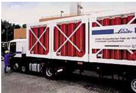
Fig. 26 Contenedores a Presión
