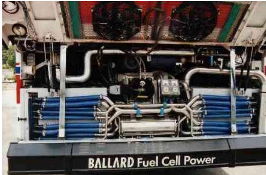
Fig. 40 Celda de Combustible de un autobús impulsado por hidrógeno
