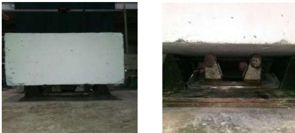
Fig. 61: Perspectiva del sistema de rodillo colocado en el extremo de la viga.
