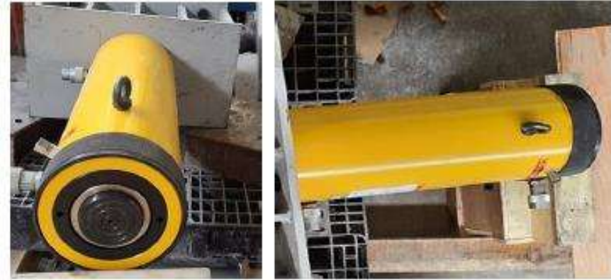
Fig. 54: Actuador de doble acción: Empuje de 100 Ton y tirón de 45 ton [34].
