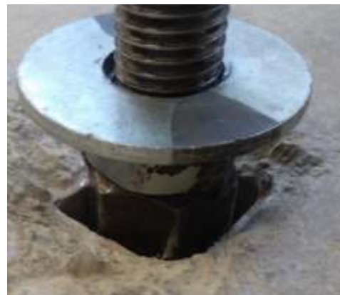
Fig. 56: Propuesta de tope para reducir la holgura entre birlo y orificio de losa de reacción.
