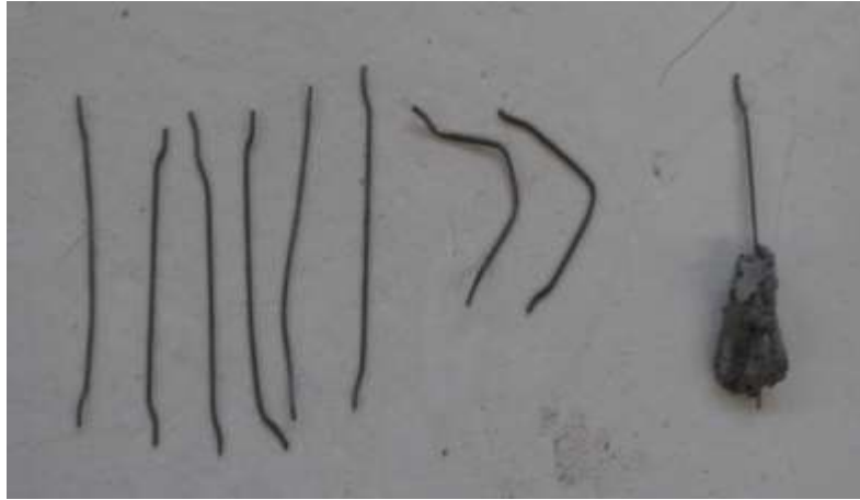
Fig. 84: Estado físico de fibras de acero después de la prueba.
