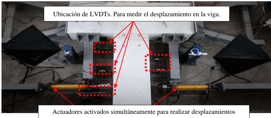
Fig. 49: Configuración de prueba: ubicación de los LVDTs y actuadores.
