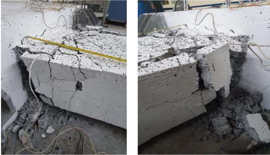
Fig. 71: Perspectiva general de fragmentación del concreto en la zona de articulación plástica.
