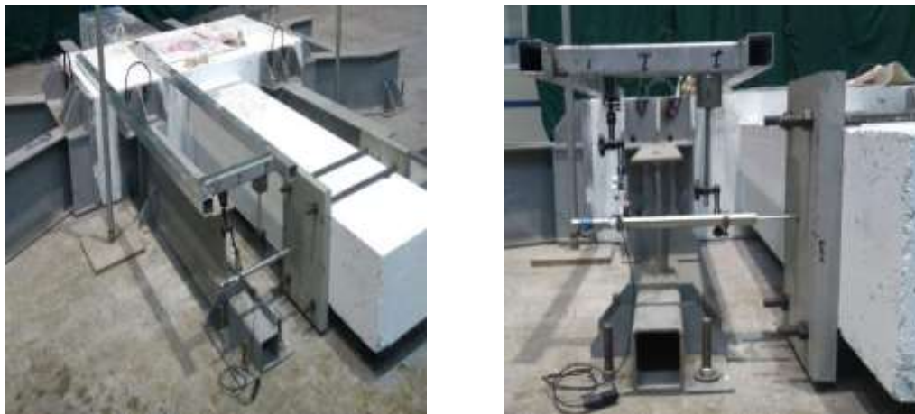
Fig. 60: Perspectiva del sistema de anclaje de LVDT's.
