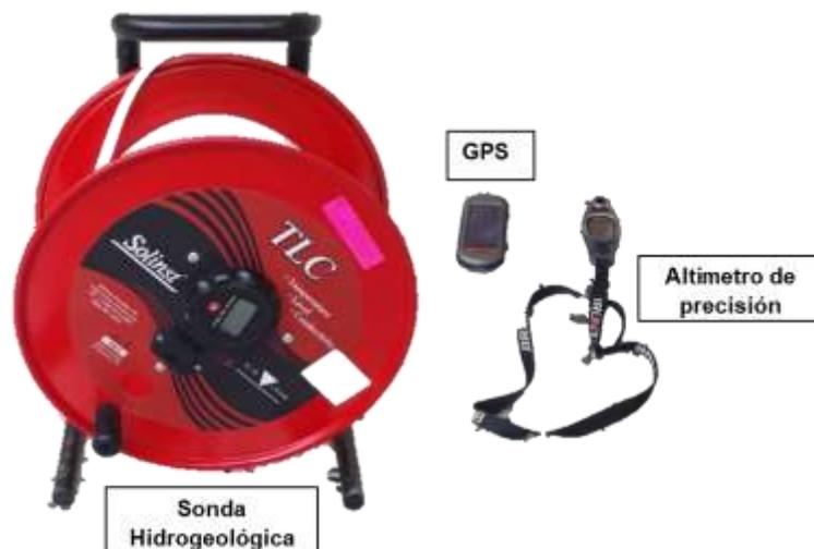
Figura 19. Equipo necesario para la medición del nivel estático.
