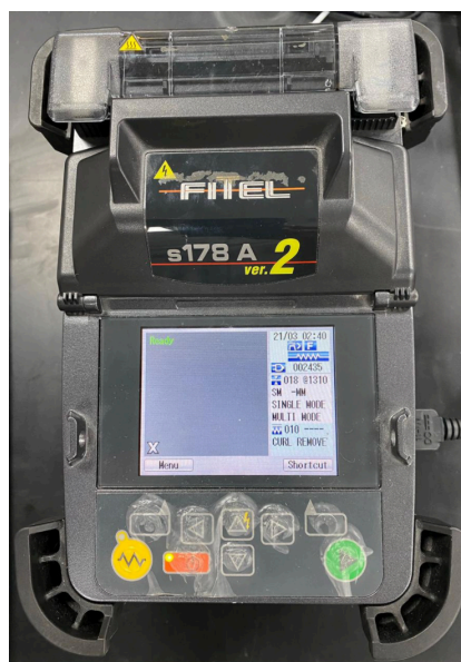
Figura 3.9: Fotografía para el empalme de la fibra óptica s178 A, versión 2
