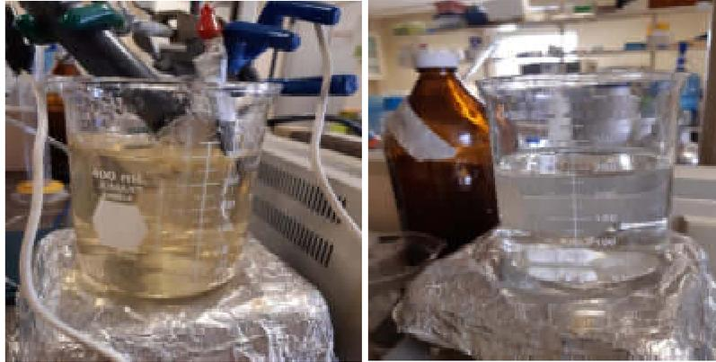
**Fig. 15.** a) Coloración de la solución al inicio del experimento; b) Decoloración de la solución después de 120 min de reacción mediante FEFS
