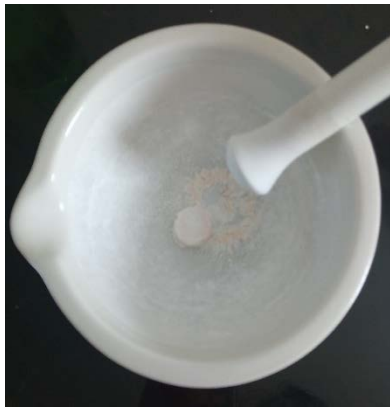
Figura 4.14 Muestra a) una probeta que se está triturando con la ayuda de la manija del mortero y b) muestra la probeta molida.
