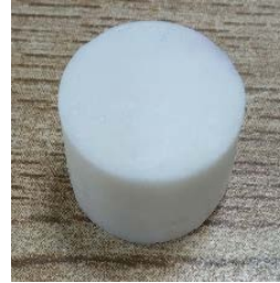
Figura 4.18 Probeta de magnesita sinterizada a partir de brucita con 1 % de nanopartículas de TiO 2 .
