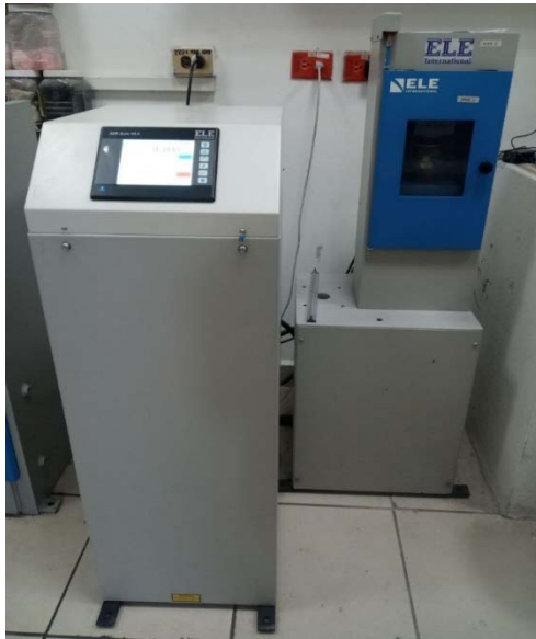
Figura 4.19 Máquina de ensayo universal marca ELE- International, modelo ADR Auto V2.0, con capacidad máxima de 250 KN.
