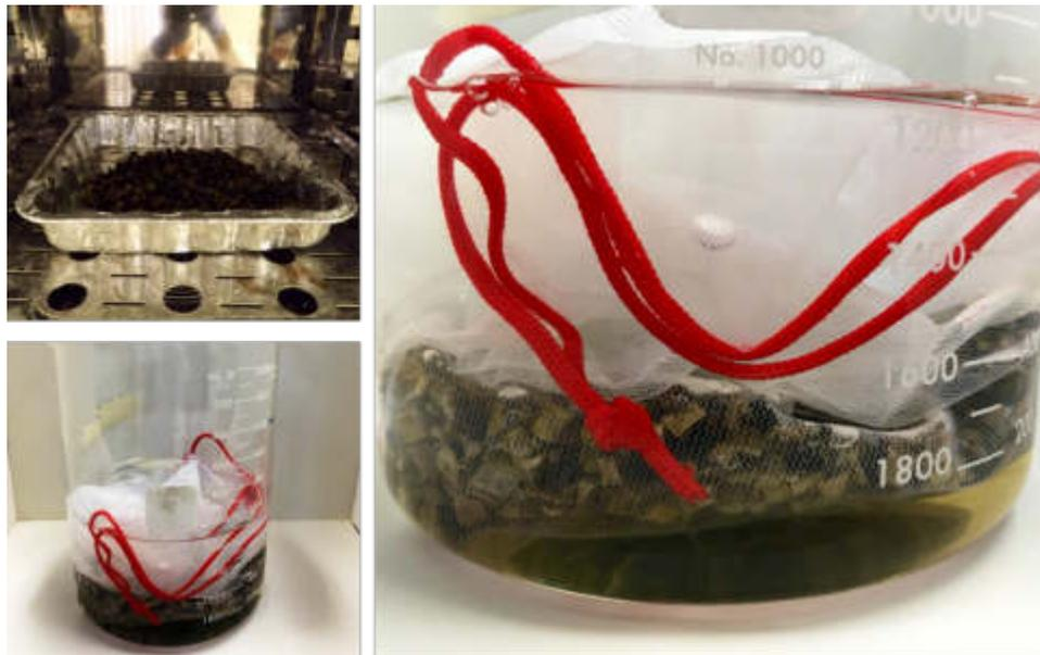
Figura 34 - Sumergimiento de la fibra dentro de bolsa permeable para determinar su absorción de agua
