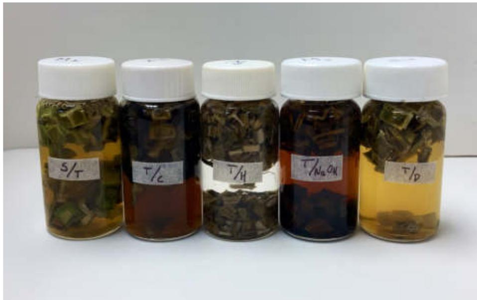
Figura 83 - Imagen comparativa de hidrosolubles extraídos sobre una masa de agregado vegetal después de haber sido sumergida en agua durante dos horas
