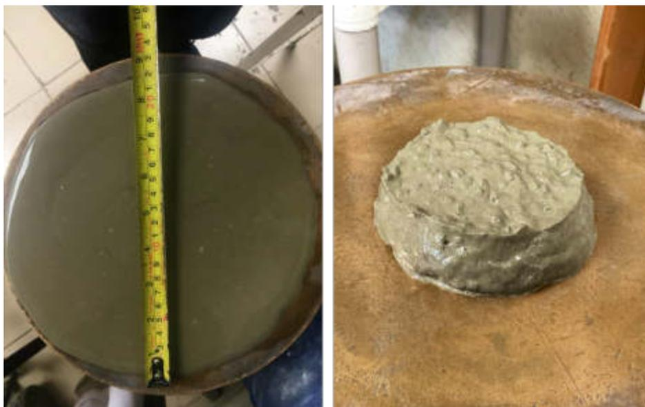
Figura 28 - Muestras de pasta de cemento con distinta fluidez después de haber sido compactadas
