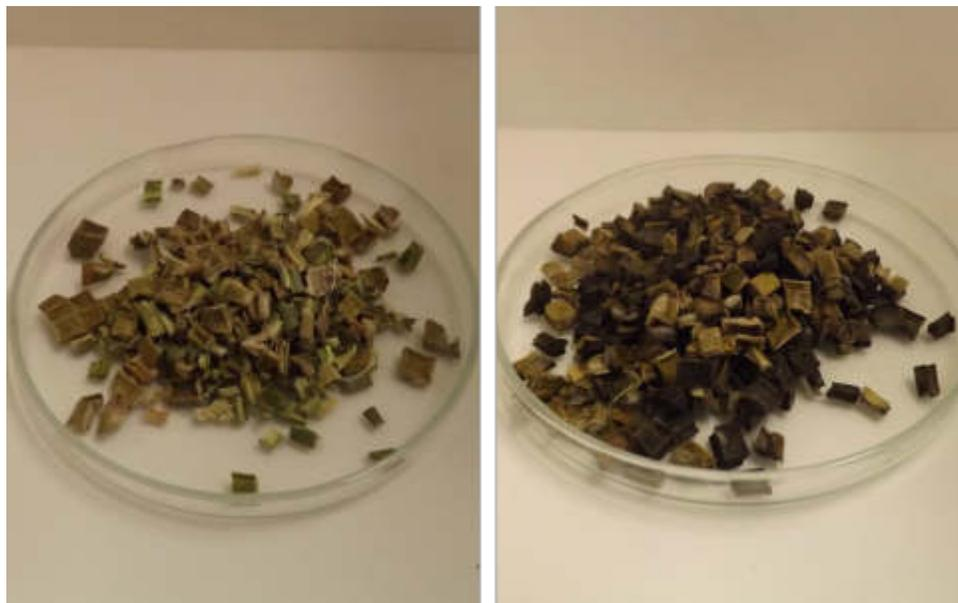
Figura 40 – Imagen comparativa que muestra a la izquierda el agregado vegetal seco mediante el procedimiento estándar y a la derecha una muestra de agregado vegetal sometido a congelamiento antes de ser secado en horno
