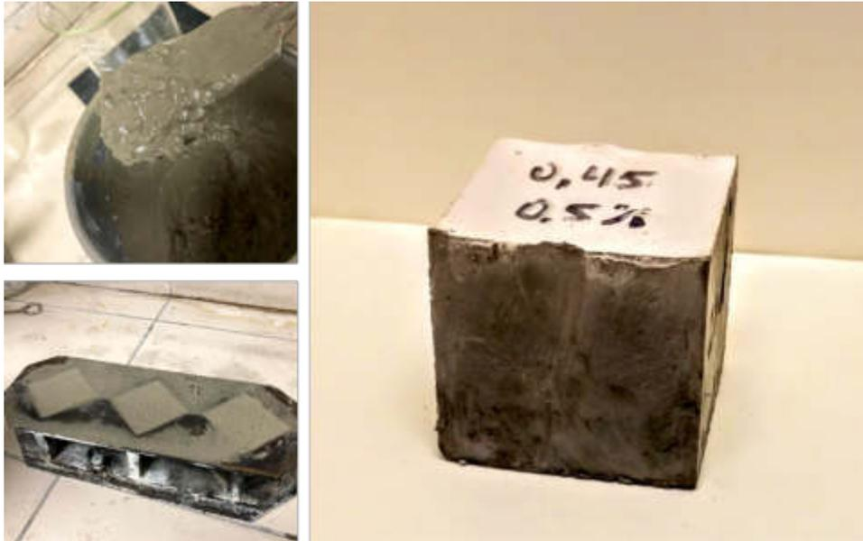
Figura 27 - Proceso de fabricación de especímenes de pasta de cemento
