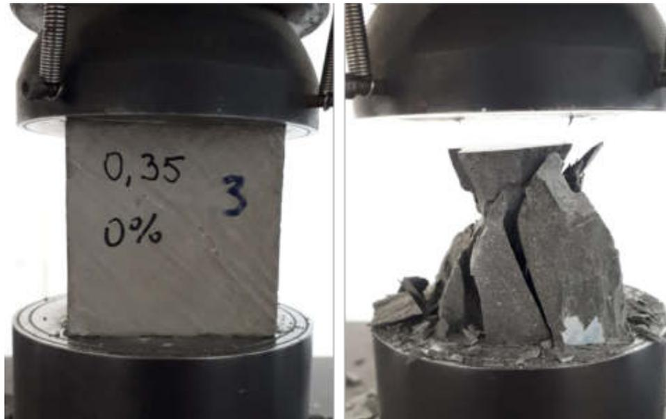
Figura 30 - Ensayo realizado sobre una muestra de pasta de cemento
