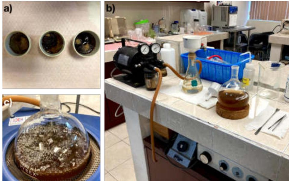
Figura 37 - Procedimiento empleado para la determinación de la lignina insoluble en ácido. a) Muestras en reposo. b) Proceso de filtrado. c) ebullición de la muestra
