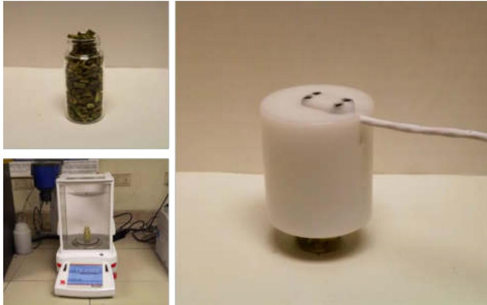
Figura 33 - Procedimiento empleado para la determinación de la conductividad térmica del agregado vegetal de Agave
