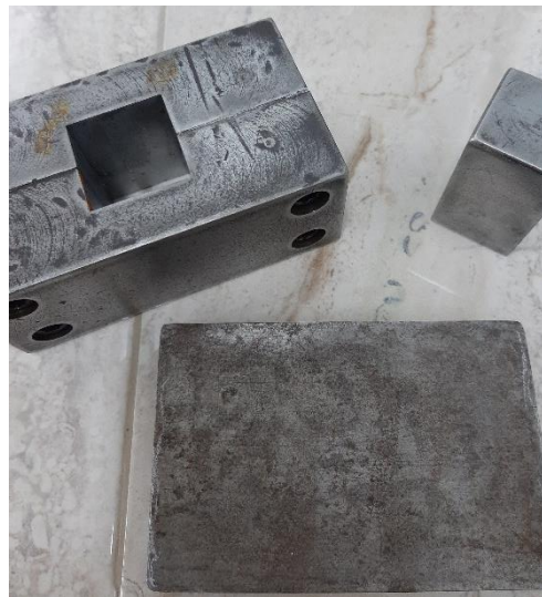
Figura 9. Molde metálico usado para el prensado de polvos.
