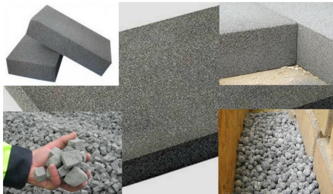
Figura 3. Aislante térmico granular: perlita a granel y miga de relleno.
