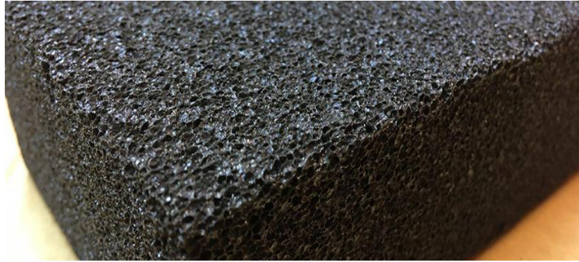
Figura 4. Aislante térmico celular: Vidrio celular.
