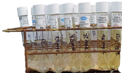
Figura 10. Prueba de nitrógeno total para las diferentes muestras de mono-digestión o co-digestión en reactor en lote o en un reactor anaerobio de flujo ascendente.
