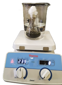
Figura 6. Pretratamiento térmico para el inóculo empleado durante las reacciones de fermentación oscura en un reactor en lote o en reactor anaerobio de flujo ascendente.
