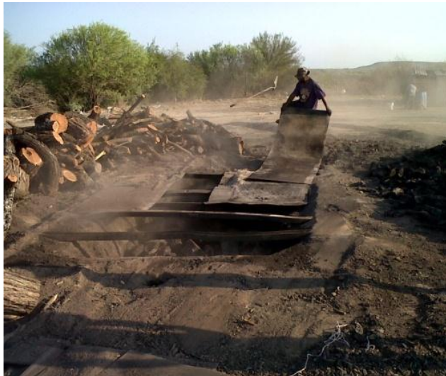
FIGURA 2. Método de fosa de tierra para la elaboración de carbón vegetal.
