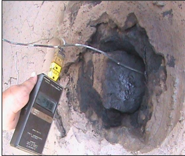
FIGURA 15. Medición de la temperatura dentro del horno con termopares.
