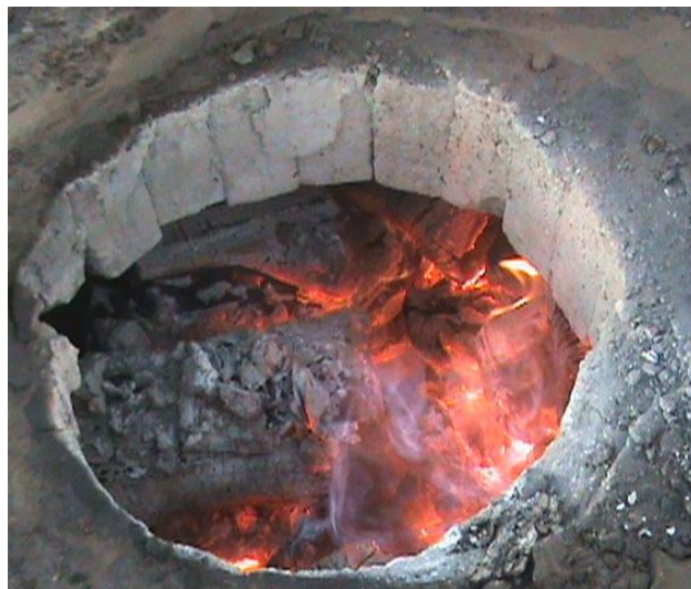
FIGURA 14. Encendido del horno por la parte superior.
