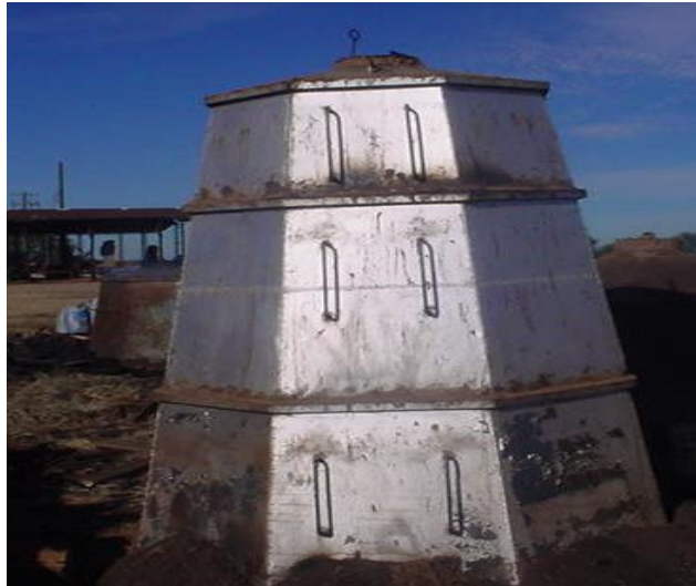
FIGURA 5. Horno tipo metálico transportable para la fabricación de carbón vegetal.
