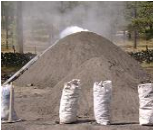
FIGURA 3. Horno de parva para la producción de carbón vegetal.
