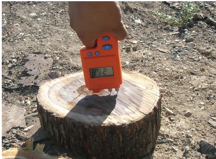
FIGURA 12. Medición de contenido de humedad por medio del xilohigrómetro.
