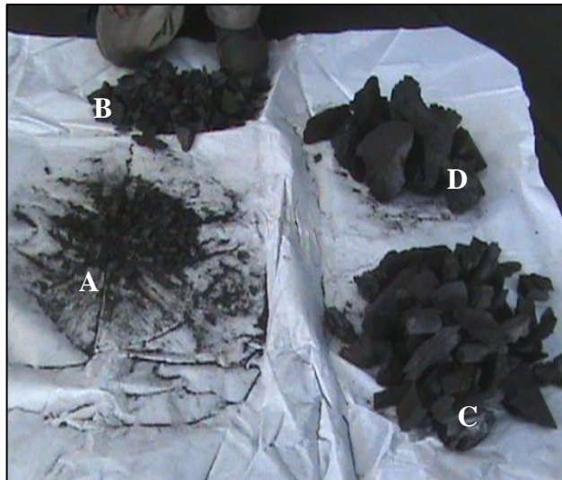
FIGURA 17. Clasificación granulométrica de carbón elaborado a partir de residuos de Quercus sideroxylla . A es clase 1 (<2.0 cm), B es clase 2 (2 cm a 5 cm), C es clase 3 (5 cm a 10 cm) y D es clase 4 (10 cm a 15 cm).
