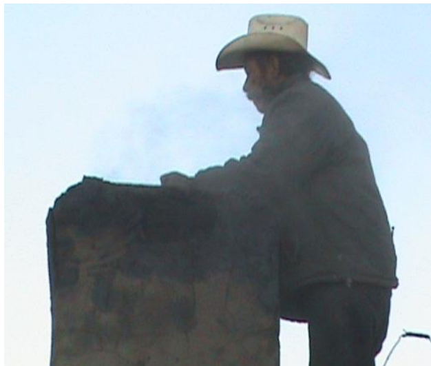
FIGURA 24. Humo azul claro liberado a 1007°C y sellado del horno para finalizar el proceso.
