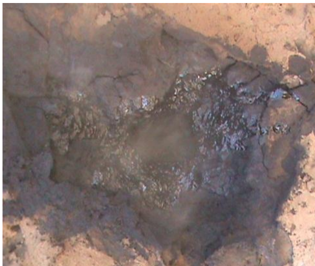
FIGURA 23. Alquitran negro liberado a través de los huidos inferiores del horno al utilizar residuos de ramas y leña cuarteada de Quercus sideroxyla .
