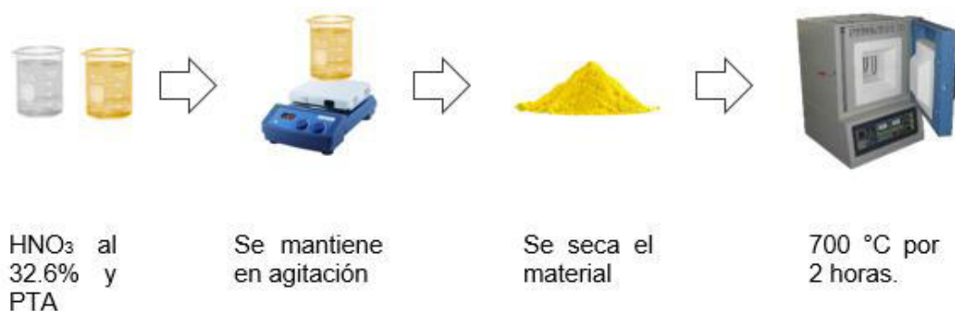
Figura 3.- Esquema del método de síntesis de nanopartículas de WO_3 .
