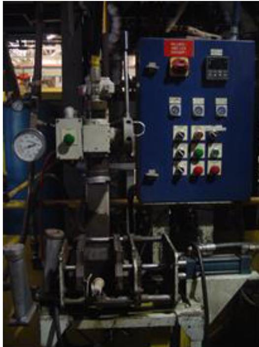
Figura 3.11 Sopladora Redford de caja caliente para elaboración de probetas.
