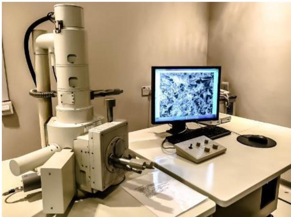
Figura 3.6 Microscopio electrónico de barrido JEOL JSM-6360LV.
