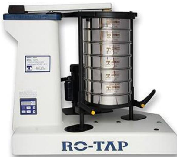
Figura 3.3 Equipo de tamización por vibrado Ro-tap.
