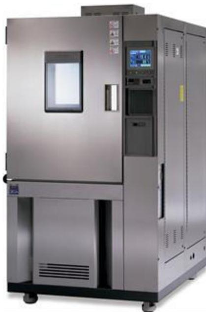
Figura 3.20 Cámara de humedad controlada ESPEC
