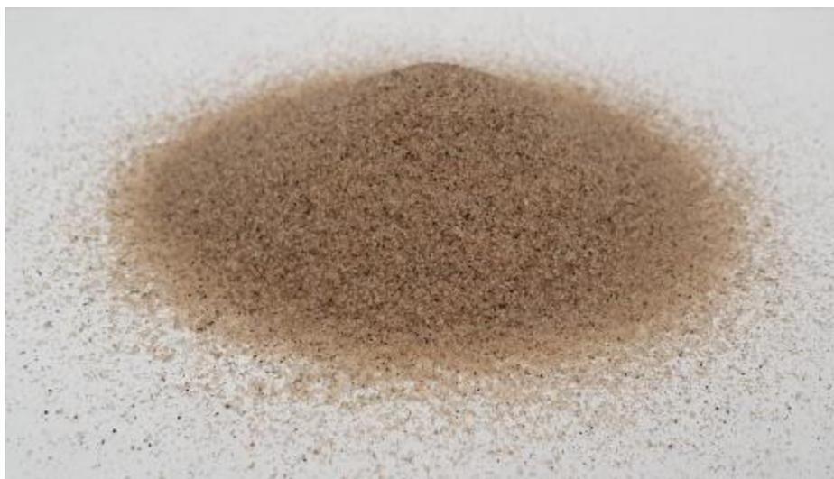
Figura 3.2 Arena de proceso que fue recuperada térmicamente.
