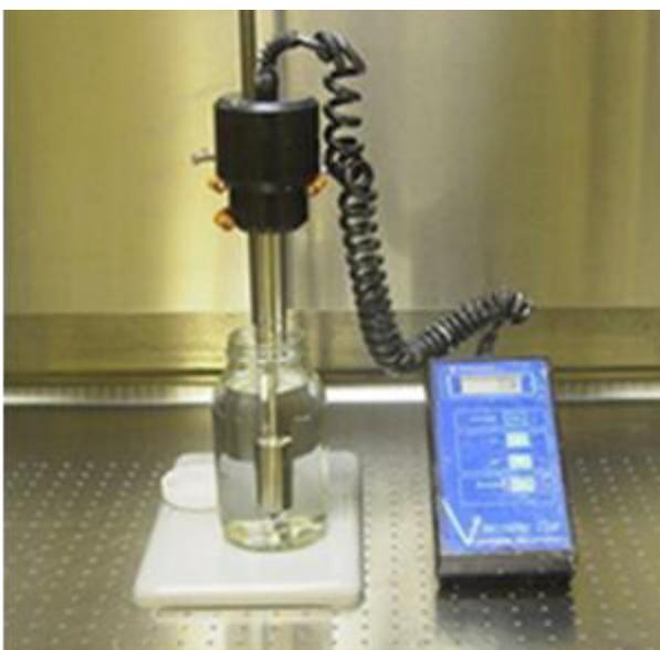
Figura 3.8 Viscosímetro portátil Viscolite VL700.
