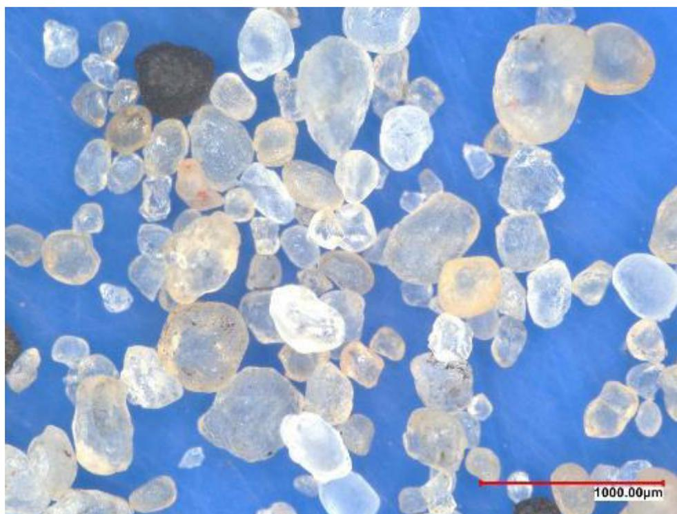
Figura 5.18 Granos de arena de proceso recuperada térmicamente.
