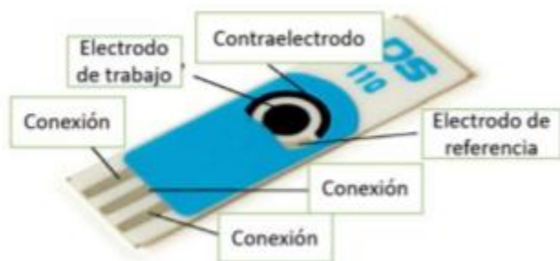
Figura 9. Laminilla de electrodos marca Metrohm DroSens.
