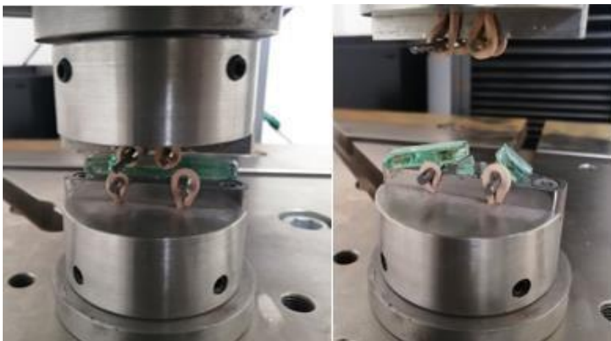
Figura 43. Prueba de flexión de cuatro puntos al inicio de la prueba (izquierda) y después de alcanzar la fuerza máxima (derecha).
