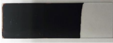
Figura 21. Película delgada de sulfuro de estaño depositada sobre sustrato de vidrio.
