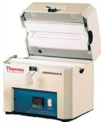
Figura 19. Horno del tipo tubular, para procesos de sulfurización.
