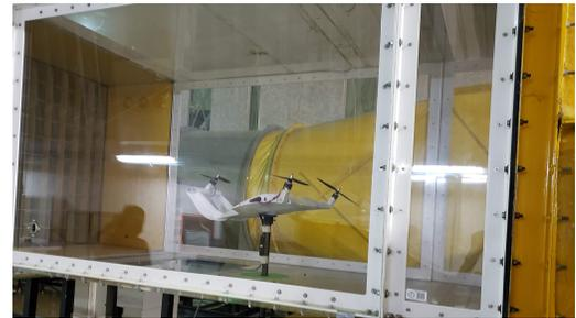
(b) Prototipo instalado dentro de la sección de pruebas del túnel de viento.
