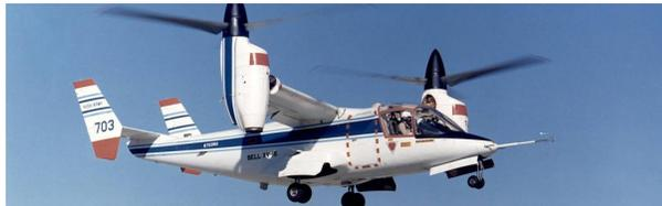
FIGURA 1.2: Convertiplano "Tiltrotor" Bell XV-15. Calzada (2003)
