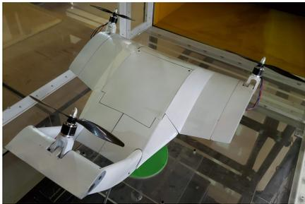
(a) Prototipo con actuadores instalados.
