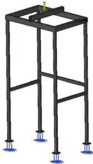
Figura 5. Configuración de cargas y apoyos en análisis de elemento finito. Fuente: Elaboración propia.
