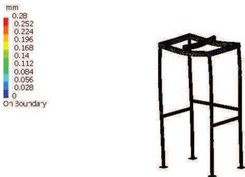
Figura 7. Deformación en armadura sometida a cargas. Fuente: Elaboración propia.
