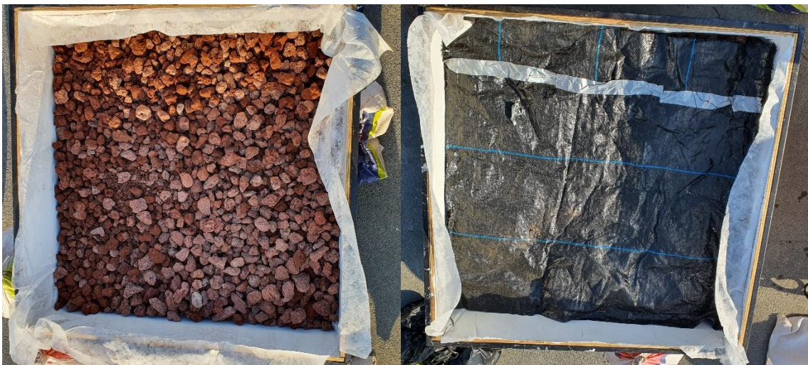
Figura 3.9. Capa drenante (roca volcánica de jardinería) y capa filtrante (malla geotextil).
