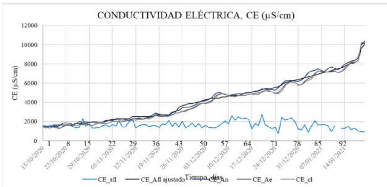
Figura 7. Determinación de la Conductividad Eléctrica en el sistema a escala de laboratorio.
