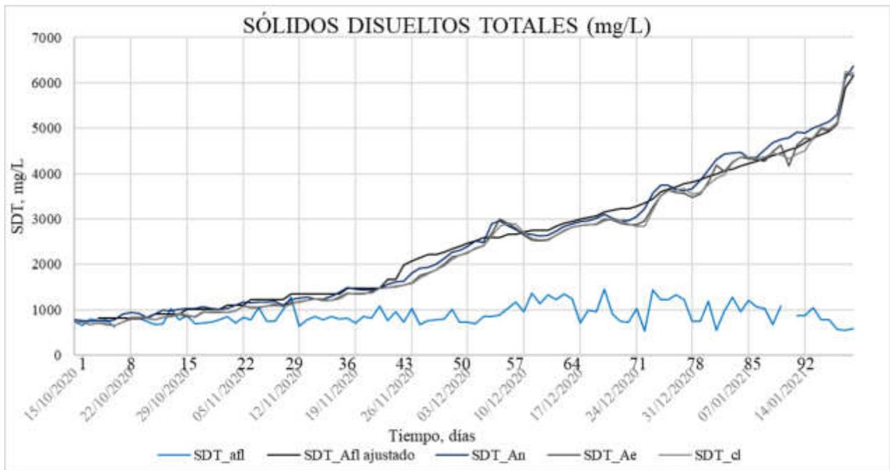
Figura 24. Determinación de los Sólidos Disueltos Totales en el sistema a escala de laboratorio.
