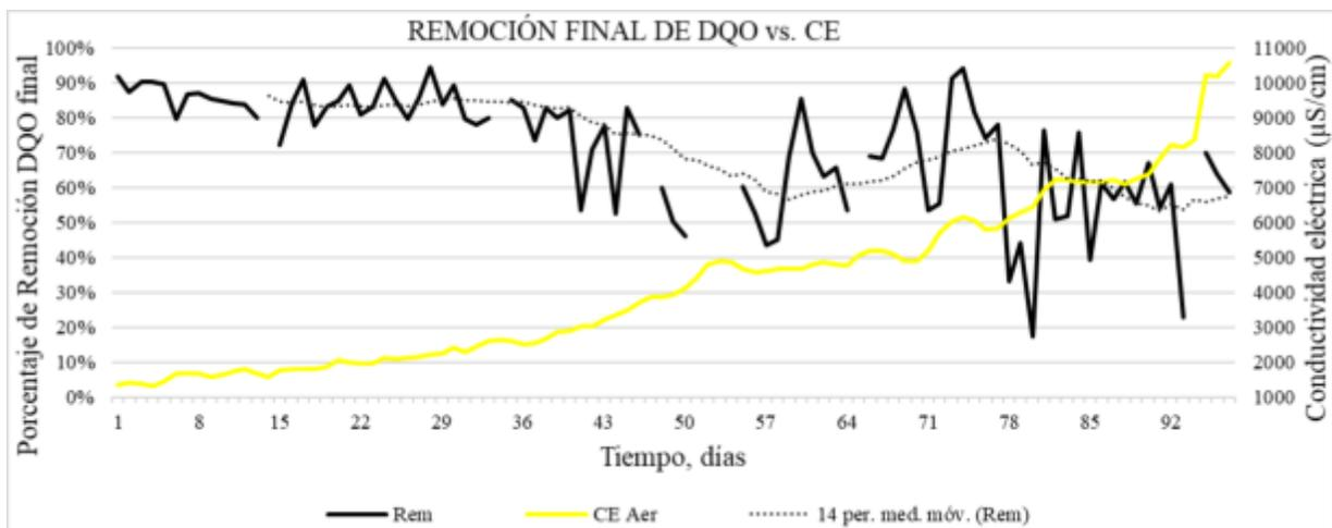
Figura 10. Eficiencia de remoción de DQO en comparación con la Conductividad Eléctrica en el reactor aerobio.
