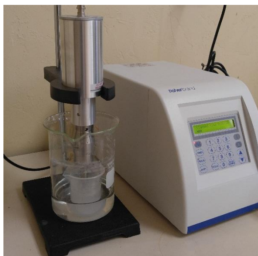
Figura 7. Dispersión de nanozeolita mediante sonicación
