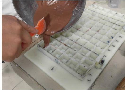
Figura 9. Encofrado de pastas
