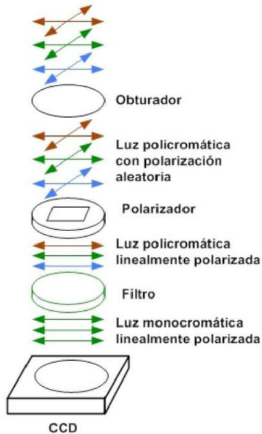
Figura 19: Diagrama esquemático de un polarímetro de imagen. El primer elemento del arreglo óptico es el analizador. Luego se tiene un filtro que selecciona la componente linealmente polarizada en un cierto ancho de banda (Hiriart et al., 2005).
