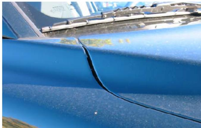
FIGURA 2.17: Ejemplo de abertura (GAP) en una zona visible del vehículo (Söderberg *et al.* (2006)).
