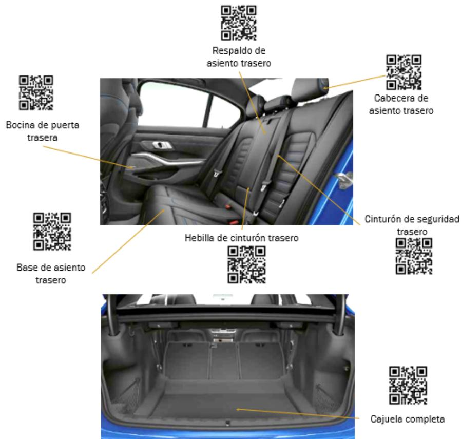
FIGURA 4.8: Componentes y área con mayor interacción en el compartimiento trasero.
