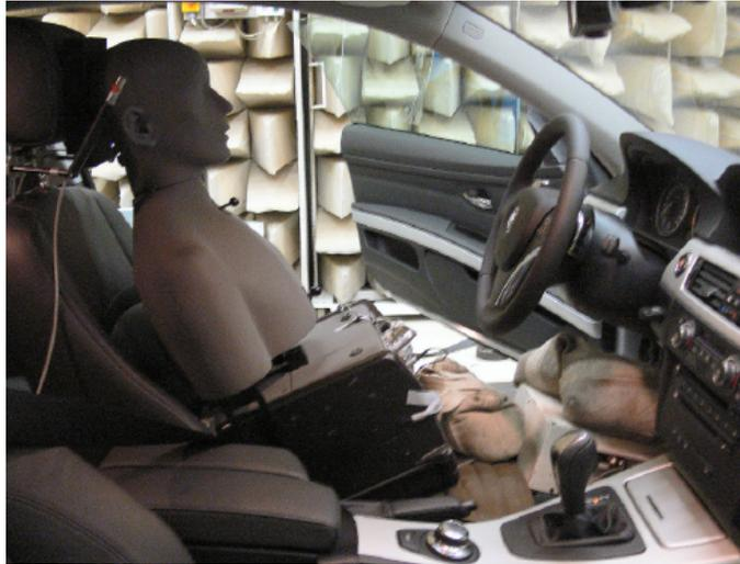
FIGURA 2.7: Grabación de sonido en el interior del vehículo con una cabeza artificial (Weber (2009)).
