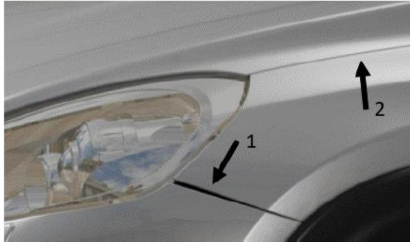
FIGURA 2.20: Ejemplo de líneas de separación (Wärmefjord *et al.* (2020)).
