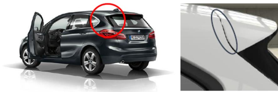
FIGURA 3.5: Baja calidad de perfección en las líneas de separación (Striegel *et al.* (2017)).
