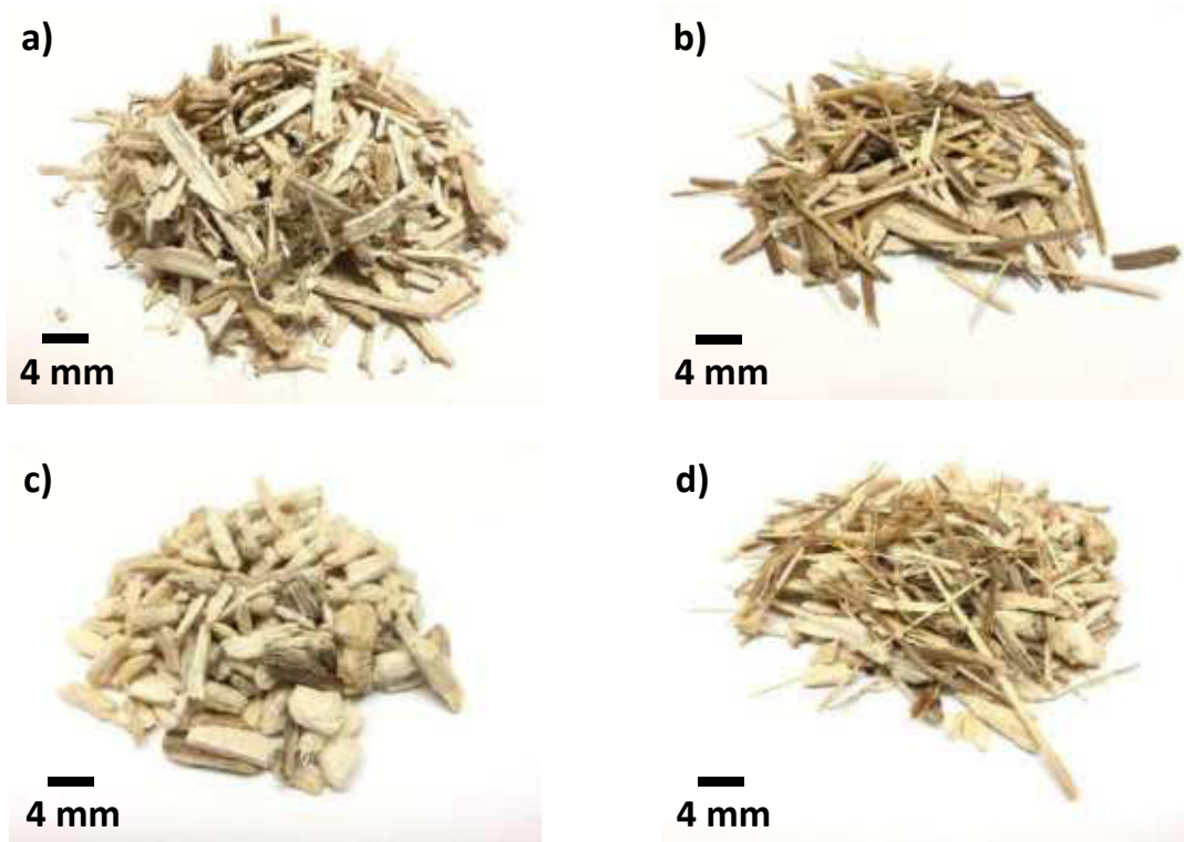
Figura 3.11. Bio-agregados obtenidos del tallo de girasol: a) Cáñamo (H), b) Corteza de maíz (SB), c) Médula de maíz (SP), d) Mezcla de corteza y médula de maíz (SM)
