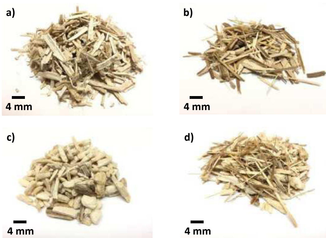
Figura 6. Bio-agregados obtenidos del tallo de girasol: a) Cáñamo (H), b) Corteza de maíz (SB), c) Médula de maíz (SP), d) Mezcla de corteza y médula de maíz (SM)
