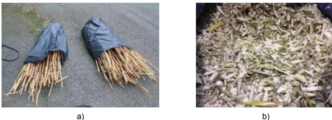
Figura 3.7. Molienda de los tallos de maíz, a) Tallos de maíz, b) Resultado de la molienda
