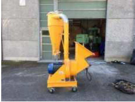
Figura 1. Molino utilizado para la trituración del tallo de girasol y maíz
