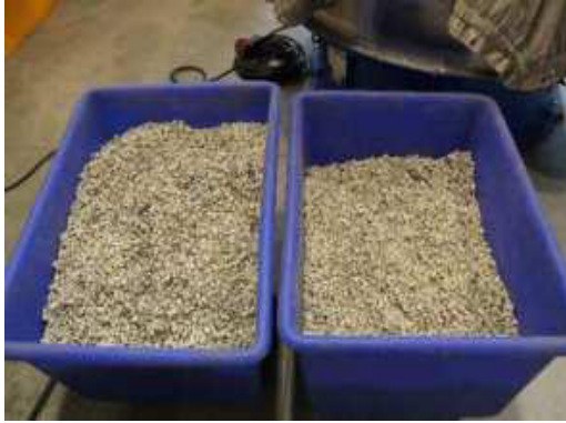
Figura 3.4. Proceso de obtención de los bio-agregados del tallo de girasol: a) Alimentación del sistema, b) Sistema de almacenamiento, c) Resultado del primer proceso de separación, d) Separación de la corteza de la médula, e) Médula de girasol separada y, f) Corteza separada.
