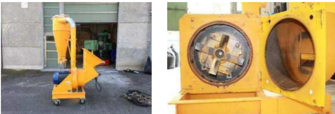
Figura 2.16. Molino utilizado para la trituración del tallo de girasol y maíz
