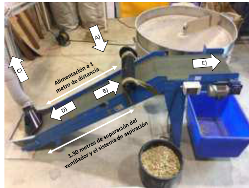
Figura 2.17. Sistema de separación de bio-agregados
