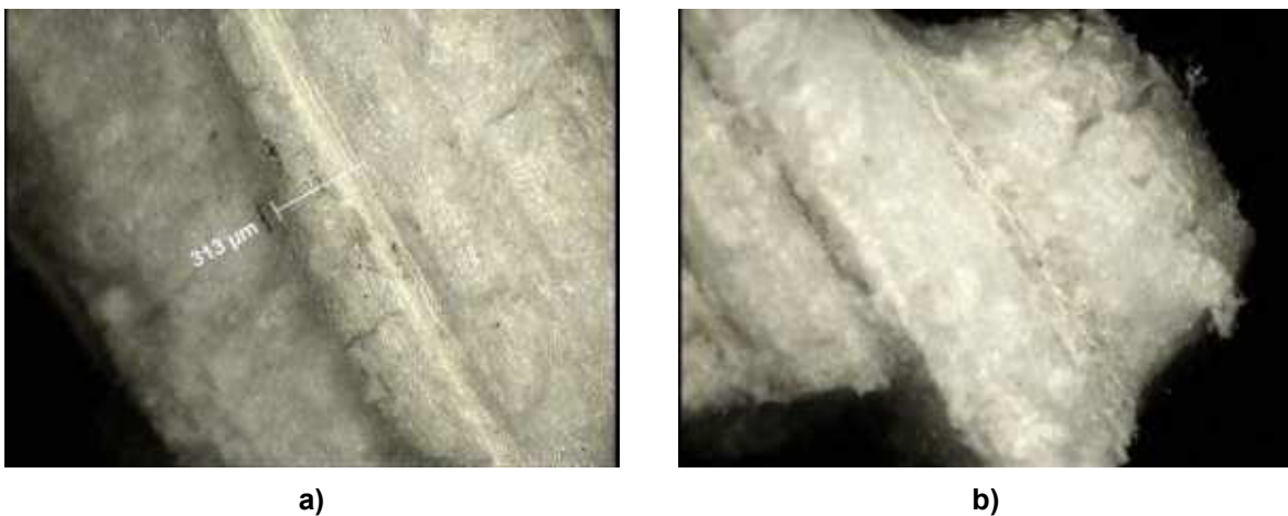
Figura 3.15. a) Magnificación a 50x de una partícula de médula de girasol, b) Magnificación a 175x de una fibra de médula de girasol
