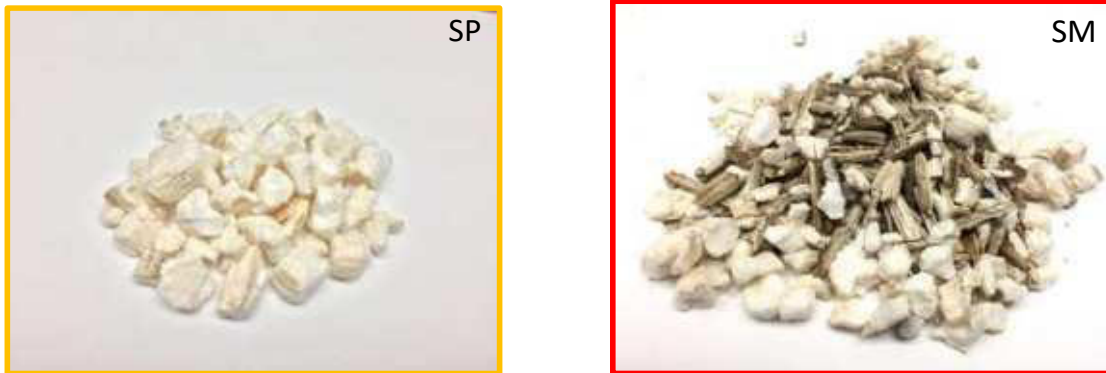
Figura 3.34. Intervalo de circularidad y morfología de las partículas: cáñamo (H), corteza de girasol (SB), médula de girasol (SP) y mezcla de corteza y médula de girasol (SM)
