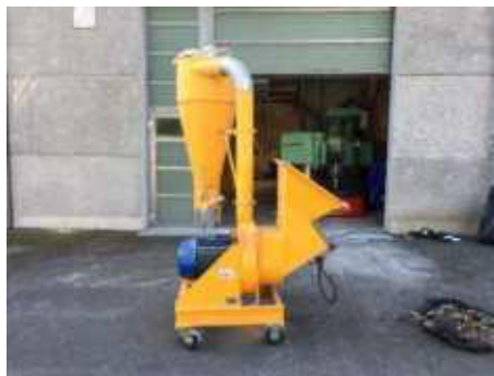
Figure 1. Moulin utilisé pour broyer les tiges de tournesol et de maïs
