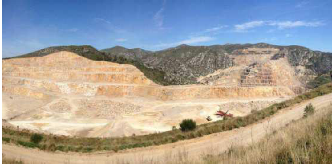
Figura 1.8. Cantera de piedra caliza (grupo ciment Català)
