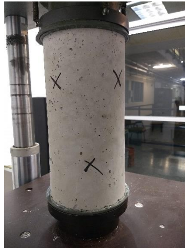
Ilustración 22. Cilindro estándar de concreto de 100 x 200 mm para medir la resistencia a la compresión del concreto.
