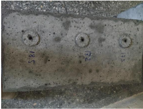
Ilustración 23. Prisma de concreto de 600x300x300 mm para ejecutar pruebas no destructivas.
