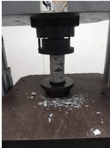
Ilustración 30. Ensayo a compresión de un núcleo de concreto de 7.5 cm.
