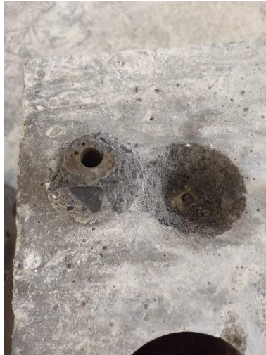
Ilustración 33. Falla correcta en la extracción de inserto por la prueba Lok-Test.
