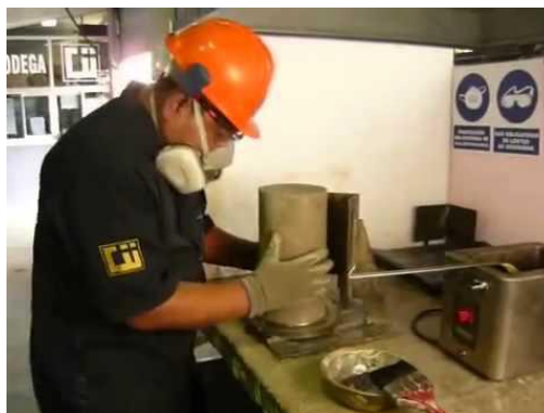
Ilustración 6. Cabeceo con azufre para cilindros estándar de concreto.[42]
