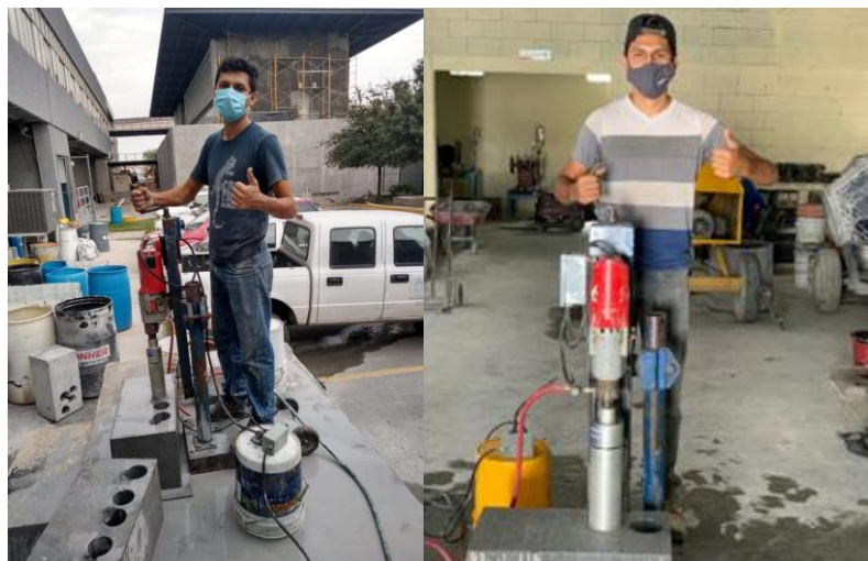
Ilustración 29. Extracción de núcleos a un prisma de concreto para su ensayo a compresión.
