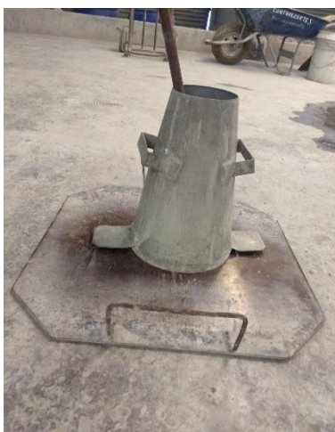
Ilustración 20. Determinación del revenimiento para las mezclas de concreto fabricadas en este proyecto.
