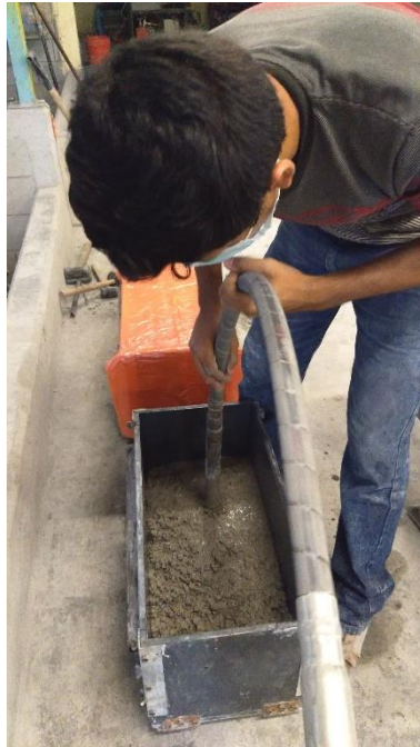
Ilustración 25. Vibrado hacia el concreto en la fabricación del prisma de concreto.
