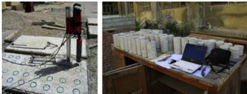
Ilustración 3. Extracción de núcleos en ubicaciones preseleccionadas (izq) y algunos núcleos extraídos (der). [11]
