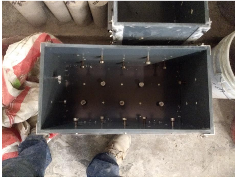
Ilustración 27. Distribución de insertos para la prueba de Lok-Test para edades de 1, 3 y 7 días.
