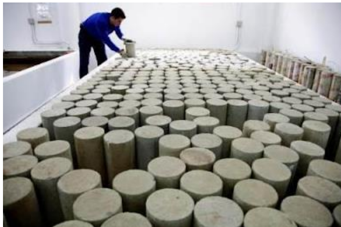
Ilustración 5. Muestra conformada por cilindros estándar de concreto de 150 x 300 mm. [40]
