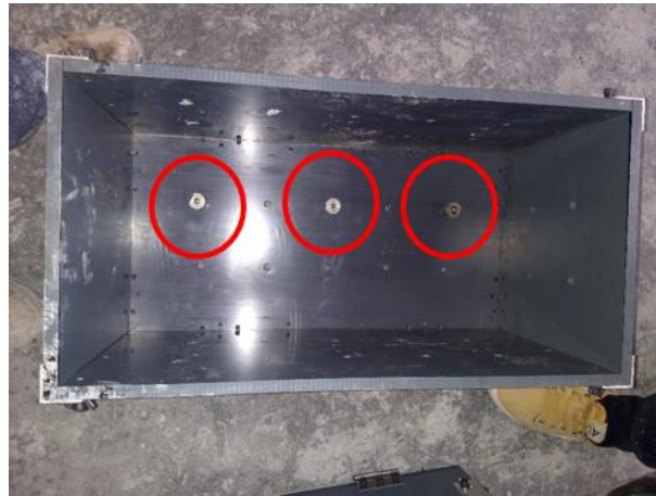
Ilustración 26. Distribución de insertos para la prueba de Lok-Test para edades de 14, 28 y 56 días.
