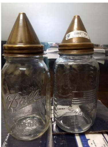
Ilustración 16. Picnómetros utilizados para la determinación de la densidad del agregado fino.
