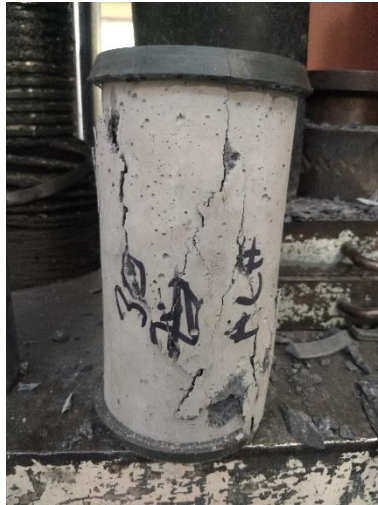
Ilustración 28. Cilindro estándar de concreto de 100x200 mm ensayado a compresión.
