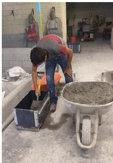
Ilustración 24. Llenado del molde de prismas de concreto en tres capas de similar volumen.
