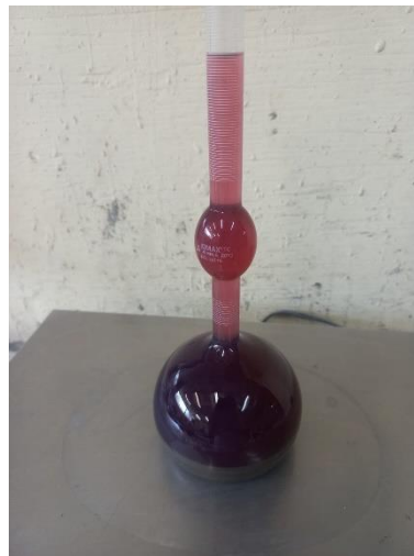
Ilustración 18. Frasco Le Chatelier con cemento y Keroseno para la determinación de la densidad del cemento.
