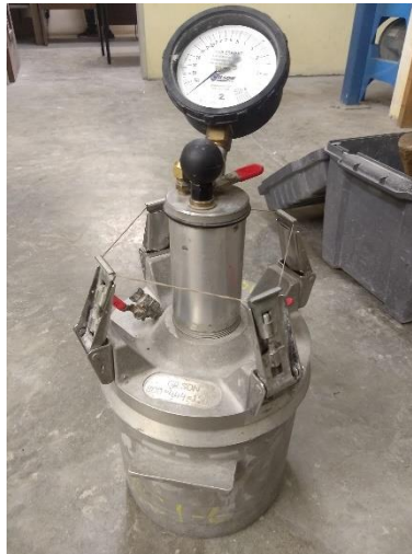
Ilustración 21. Determinación del contenido de aire en el concreto en estado fresco por ASTM C231.
