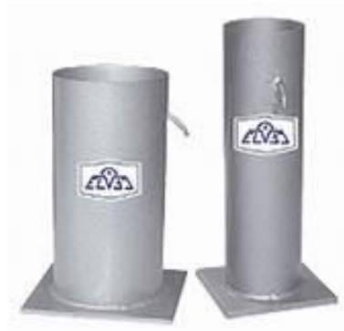
Ilustración 17. Picnómetro tipo sifón de 15 cm de diámetro x 30 cm de altura (izquierda) y Picnómetro tipo sifón de 10 cm de diámetro x 35 cm de altura (derecha).[73]
