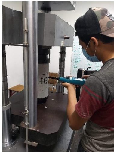
Ilustración 31. Determinación del número de rebote a un cilindro de 150x300 mm precargado a 3 MPa.
