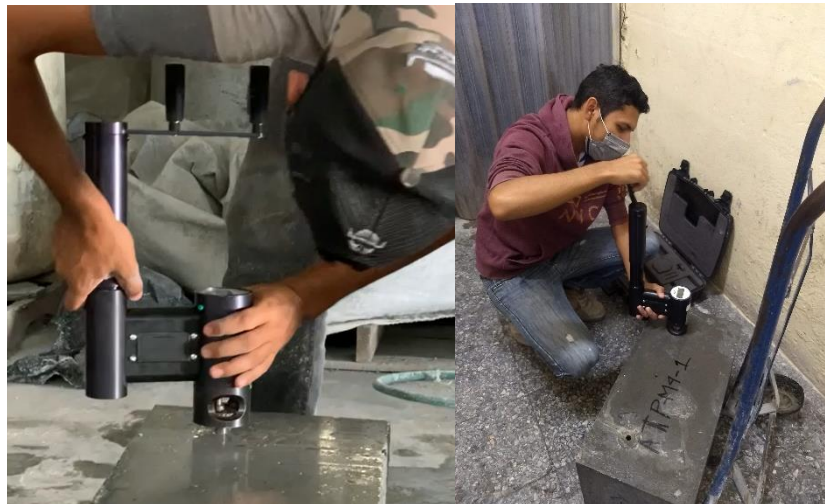
Ilustración 32. Ejecución del ensayo Lok-Test (pull-out) a un prisma de concreto.
