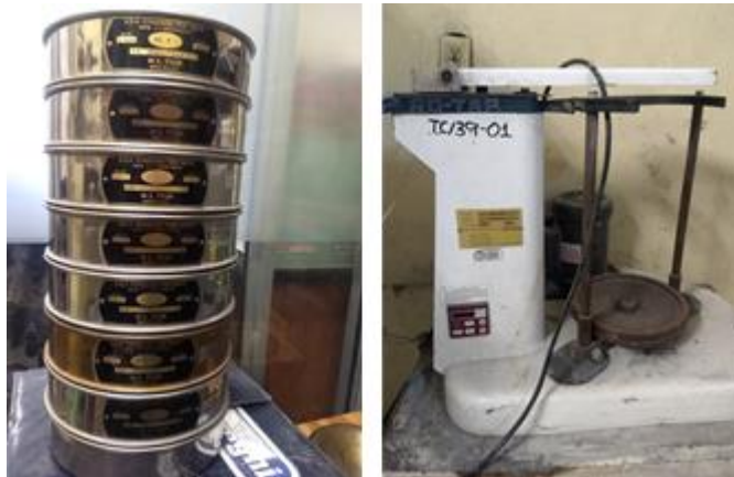
Ilustración 19. Mallas utilizadas para determinar la granulometría del agregado fino (izquierdo) y equipo de cribado mecánico empleado para este ensaye (derecho).
