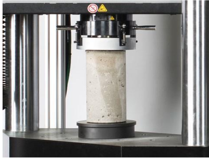
Ilustración 2. Ensayo a compresión de cilindro de concreto de 150 x 300 mm. [3]
