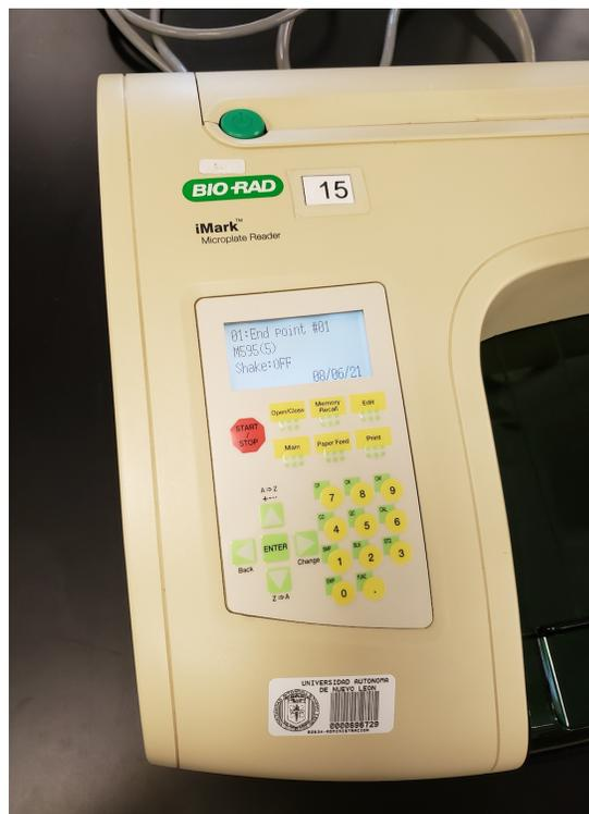
Figura 15: Espectrofotómetro iMark Microplate Reader
