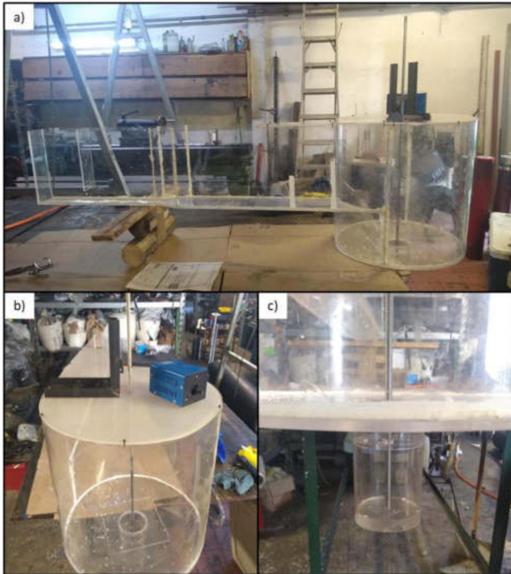
Figura 6.20. Construcción del cubilete y el canal de entrada: a) Vista lateral del cubilete, b) Vista frontal y; c) Detalle del orificio de salida y guía del eje de la turbina.
