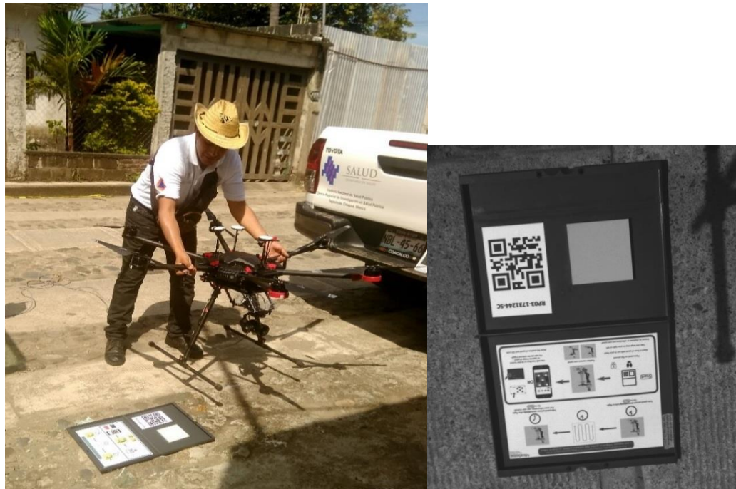
Figura 3. Calibración de la cámara MicaSense® por parte de personal de CENAPRED (izquierda), instrucciones para calibración (derecha).
