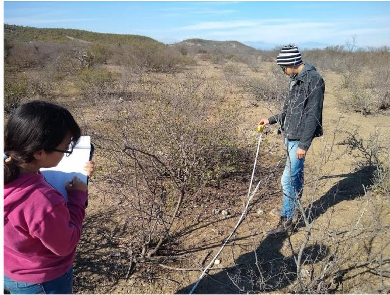
**Figura 3. Registro de cobertura interceptada mediante la técnica de puntos de contacto.**
