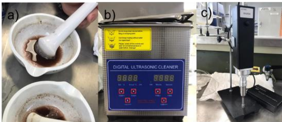
Figura 4. Tratamientos utilizados en la extracción de R-PE a) Maceración b) Baño ultrasónico y c) Sonda ultrasónica.
