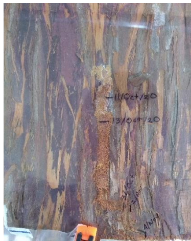
Figura 23. Galería construida de manera perpendicular y paralela a los haces vasculares.
