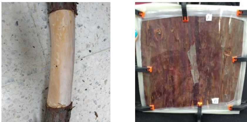
Figura 11. Rama de Juniperus flaccida Schldtl con láminas de floema extraídas (derecha), representación de la técnica del sándwich (izquierda).
