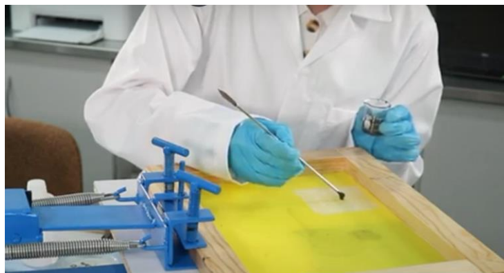
Fig. 20 Aplicación de pasta solar \text{TiO}_2 con QD SnS por método de serigrafía a un sustrato FTO en una malla de 90 hilos.
